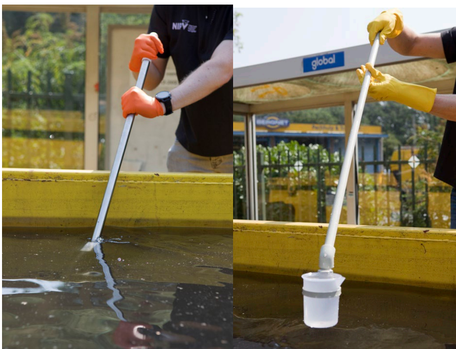
Figuur 1.3 Links roeren van het water, rechts nemen van watermonster
