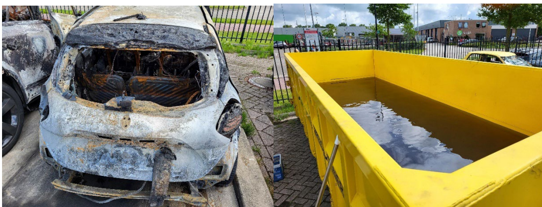
Figuur 1.2 Links: uitgebrand voertuig uit dompelcontainer, rechts: dompelcontainer met achtergebleven vervuild koelwater
