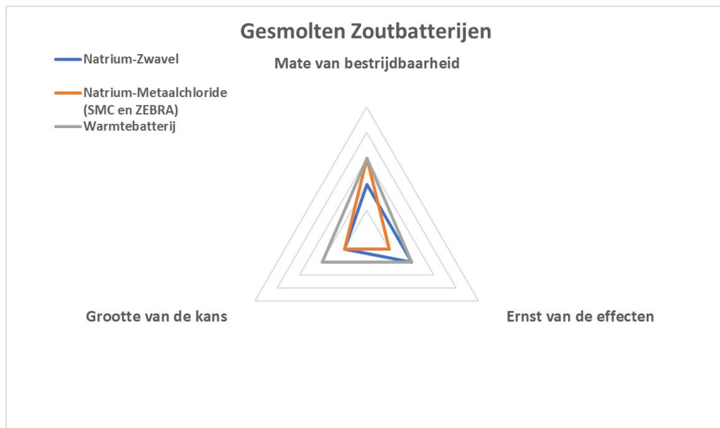
Figuur 4.3 Radardiagram veiligheidsanalyse gesmolten zoutbatterijen
