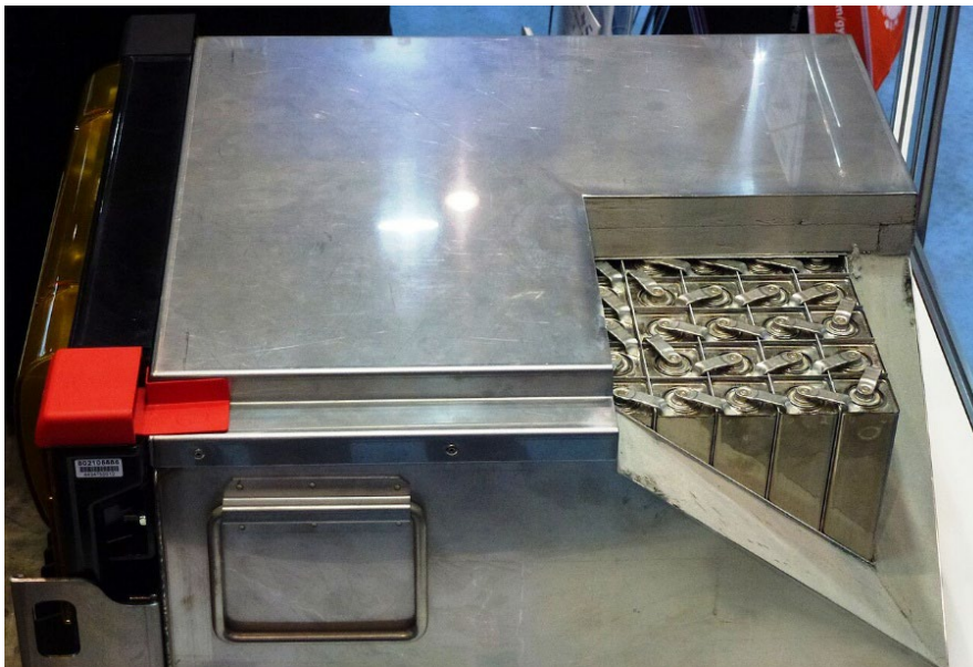
Figuur 2.1 Demo-model gesmolten zoutbatterijmodule, subtype natrium-nikkelchloride (ZEBRA-batterij, zie ook paragraaf 2.3.2) (bron: Rudolf Simon, 2012)
