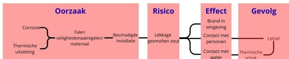
Figuur 4.1 Gebeurtenissenschema bij falen van gesmolten zoutbatterijen
