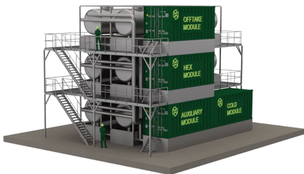
Figuur 3.2 Thermische energieopslag in opslagtanks met gesmolten zout (bron: Kooijman, 2025)
