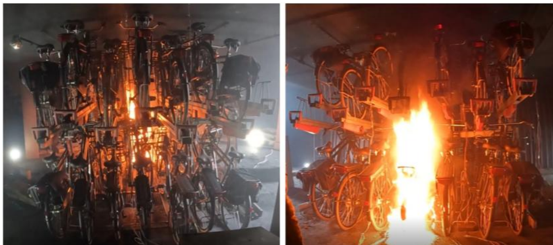
Figuur 2.3 Brandontwikkeling linkerzijde stalling (links) en rechterzijde stalling (rechts) 7,5 minuut na start experiment
