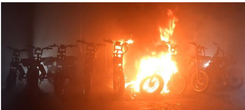
Figuur 2.48 Brandontwikkeling fatbikes met sprinkler HC-2 10 minuten na start experiment (enkele seconden voor activatie sprinklers)
