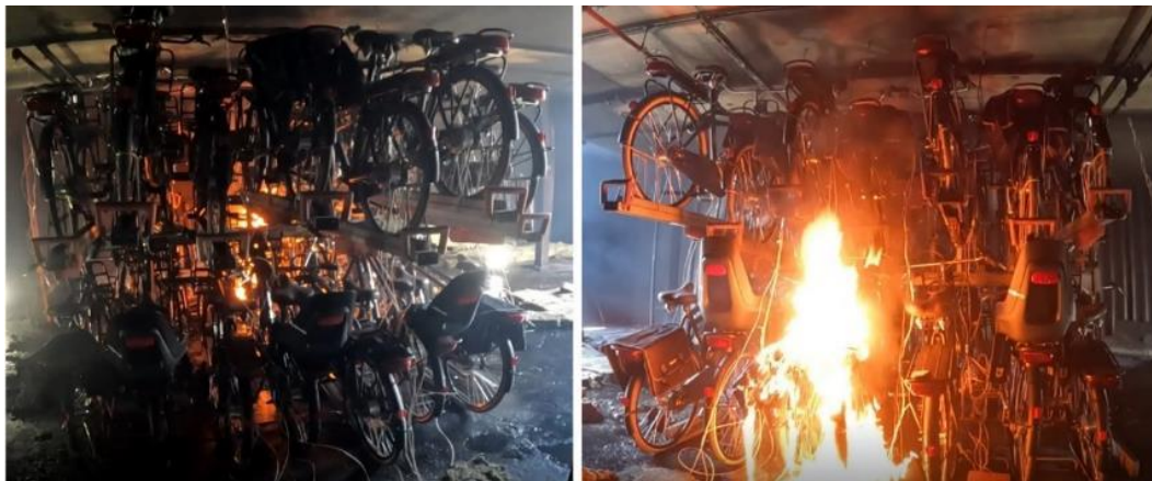
Figuur 2.14 Brandontwikkeling linkerzijde stalling (links) en rechterzijde stalling (rechts) 6,5 minuut na start experiment
