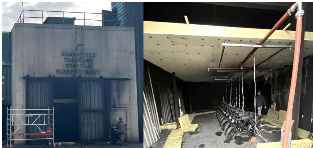
Figuur 1.1 Testgebouw met deel van inpandige stalling nagebouwd
