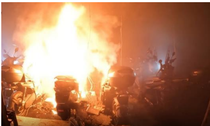
Figuur 2.57 Brandontwikkeling scooters met sprinkler HC-3 4 minuten na start experiment (enkele seconden voor activatie sprinkler)
