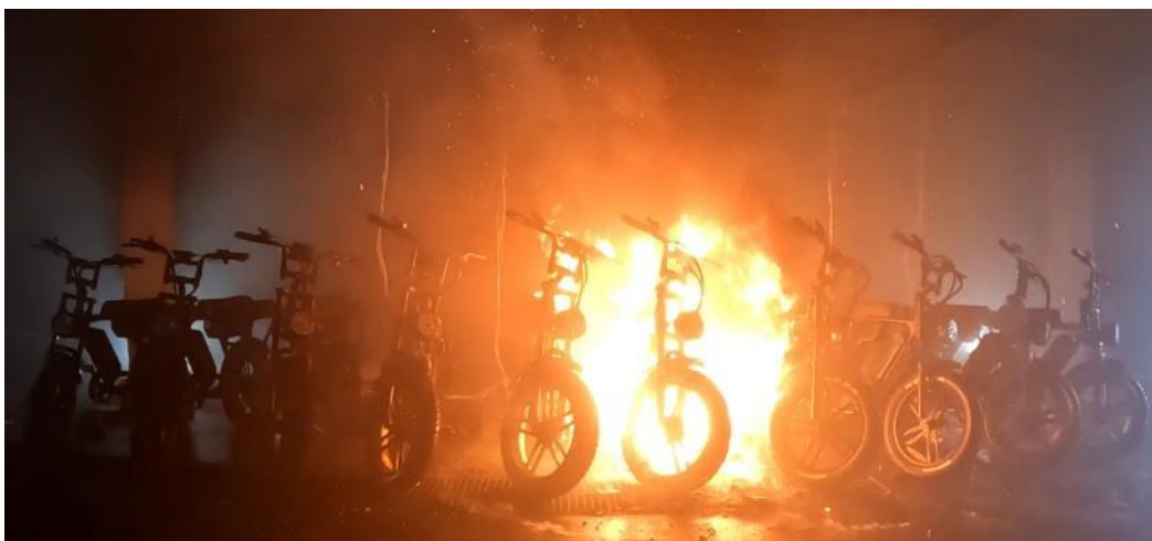
Figuur 2.26 Brandontwikkeling fatbikes 7,5 minuut na start experiment
