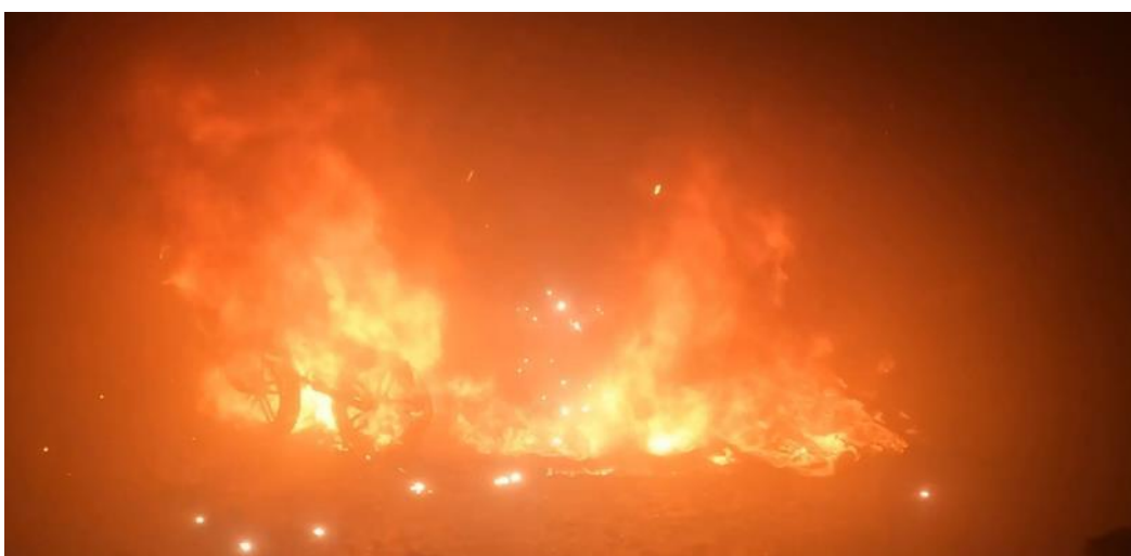
Figuur 2.28 Brandontwikkeling fatbikes 12,5 minuut na start experiment
