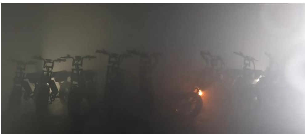
Figuur 2.50 Brandontwikkeling fatbikes met sprinkler HC-2 30 minuten na start experiment (20 minuten na activatie sprinklers)
