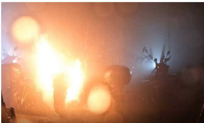
Figuur 2.60 Brandontwikkeling scooters met sprinkler HC-3 10 minuten na start experiment (6 minuten na activatie sprinklers)
