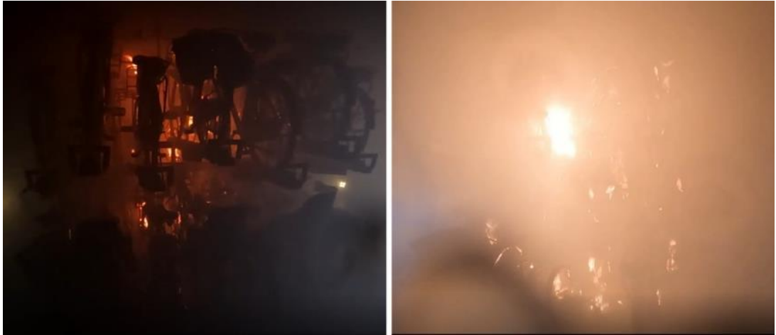
Figuur 2.17 Brandontwikkeling linkerzijde stalling (links) en rechterzijde stalling (rechts) 14,5 minuut na start experiment (circa 5 minuten na activatie sprinkler)
