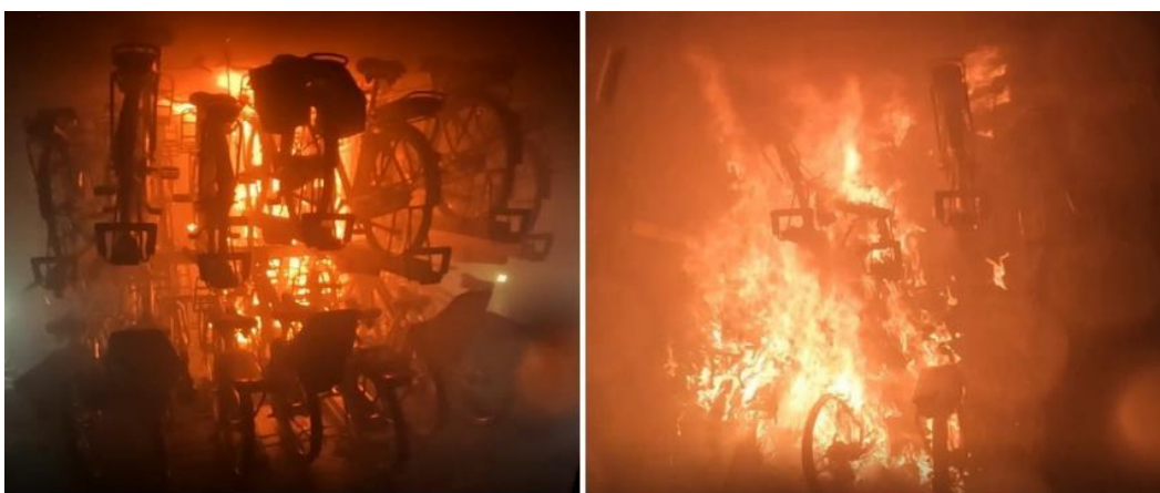
Figuur 2.16 Brandontwikkeling linkerzijde stalling (links) en rechterzijde stalling (rechts) 10,5 minuut na start experiment (circa 1 minuut na activatie sprinkler)
