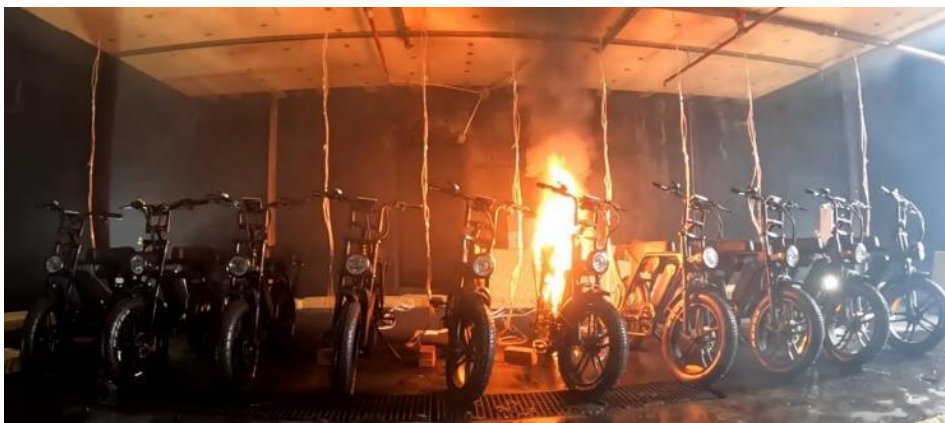
Figuur 2.36 Brandontwikkeling fatbikes met sprinkler HC-3 5 minuten na start experiment
