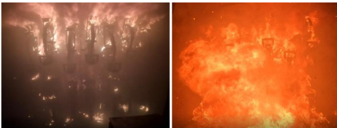
Figuur 2.6 Brandontwikkeling linkerzijde stalling (links) en rechterzijde stalling (rechts) 11,5 minuut na start experiment
