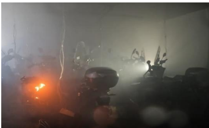
Figuur 2.61 Brandontwikkeling scooters met sprinkler HC-3 30 minuten na start experiment (26 minuten na activatie sprinklers)
