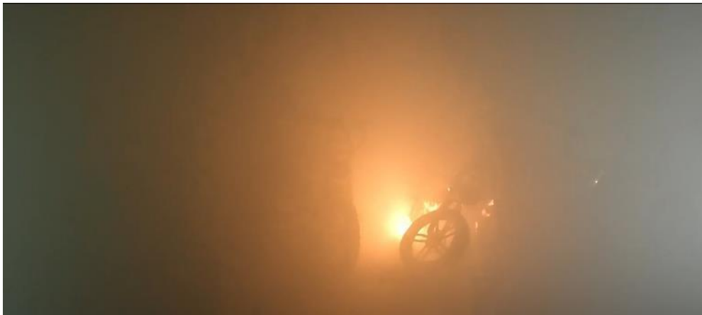
Figuur 2.49 Brandontwikkeling fatbikes met sprinkler HC-2 11 minuten na start experiment (1 minuut na activatie sprinklers)
