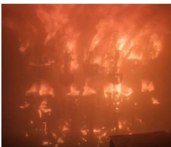
Figuur 2.7 Brandontwikkeling linkerzijde stalling (links) op 12,5 minuut na start experiment (van de rechterzijde zijn geen beelden op 12,5 minuut)
