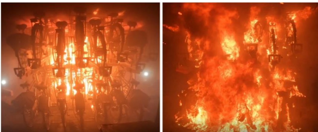
Figuur 2.5 Brandontwikkeling linkerzijde stalling (links) en rechterzijde stalling (rechts) 10,5 minuut na start experiment
