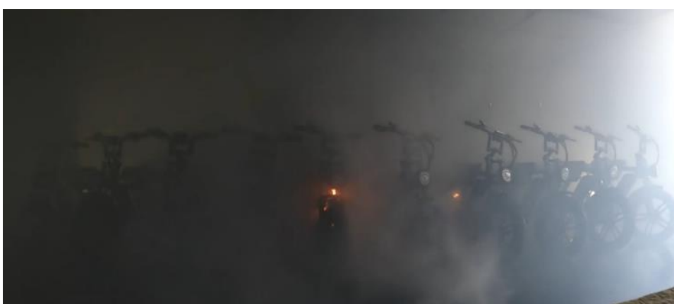
Figuur 2.38 Brandontwikkeling fatbikes met sprinkler HC-3 9,5 minuut na start experiment (1 minuut na activatie sprinkler)
