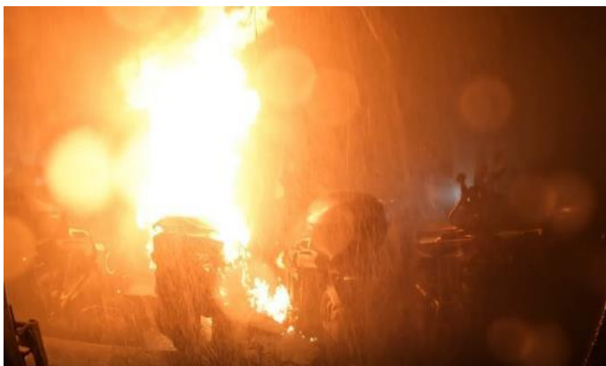
Figuur 2.58 Brandontwikkeling scooters met sprinkler HC-3 5 minuten na start experiment (1 minuut na activatie sprinklers)
