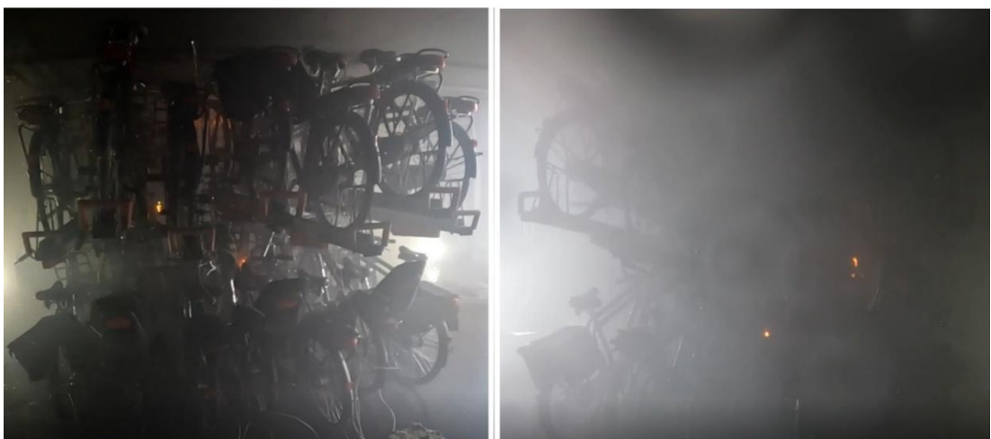
Figuur 2.19 Brandontwikkeling linkerzijde stalling (links) en rechterzijde stalling (rechts) 29,5 minuut na start experiment (circa 20 minuten na activatie sprinkler)
