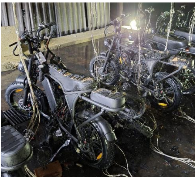
Figuur 2.51 Fatbikes F4, F5 en F6 na het experiment
