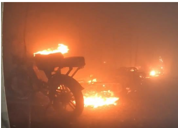
Figuur 2.29 Brandontwikkeling fatbikes 24,5 minuut na start experiment (vanuit stalling rechts voor)
