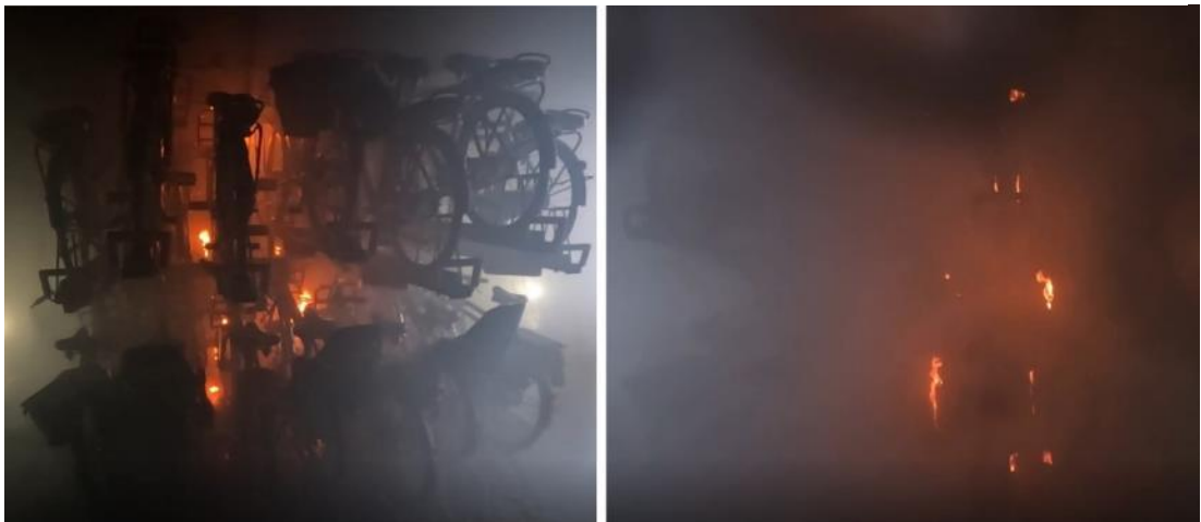
Figuur 2.18 Brandontwikkeling linkerzijde stalling (links) en rechterzijde stalling (rechts) 19,5 minuut na start experiment (circa 10 minuten na activatie sprinkler)
