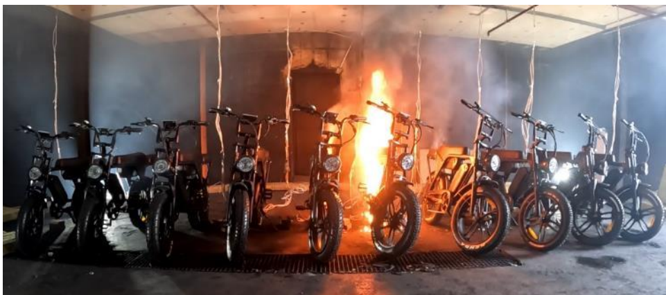
Figuur 2.46 Brandontwikkeling fatbikes met sprinkler HC-2 5 minuten na start experiment
