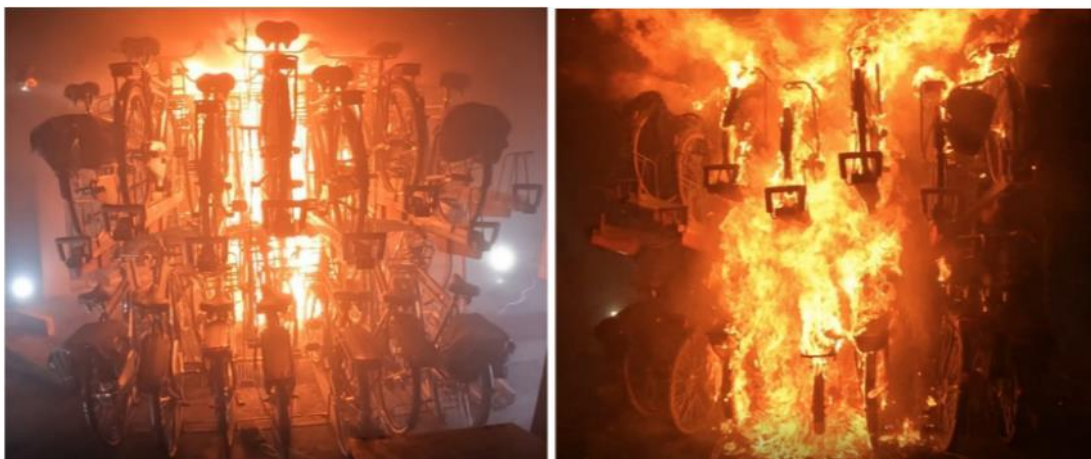
Figuur 2.4 Brandontwikkeling linkerzijde stalling (links) en rechterzijde stalling (rechts) 9,5 minuut na start experiment
