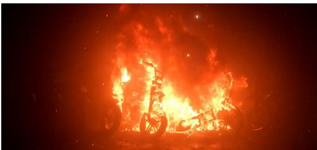
Figuur 2.27 Brandontwikkeling fatbikes 10 minuten na start experiment
