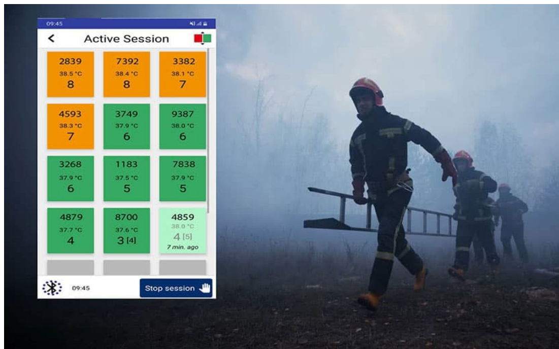
Figuur 2.1 Physical strain index zoals gecreëerd tijdens het gebruik van het ARMOR-hitte-monitorsysteem (Bron: www.armorhitemonitor.nl )
