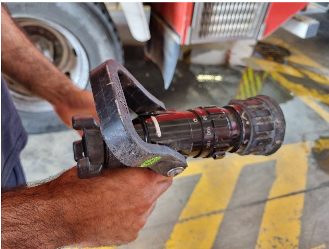
Figuur 2.10 Een straalpijp die in Catalonië bij natuurbranden gebruikt wordt
