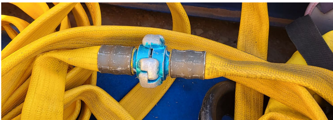
Figuur 2.8 Voorbeeld van een snelkoppeling voor de smalle slangen (25 mm) bij natuurbranden
