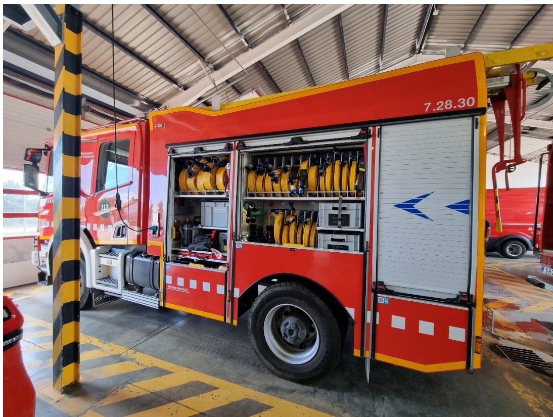
Figuur 2.7 Reguliere tankautospuiter van de Catalaanse brandweer. Rechtsboven zitten de smalle slangen (25 mm) die specifiek bij natuurbrand gebruikt worden
