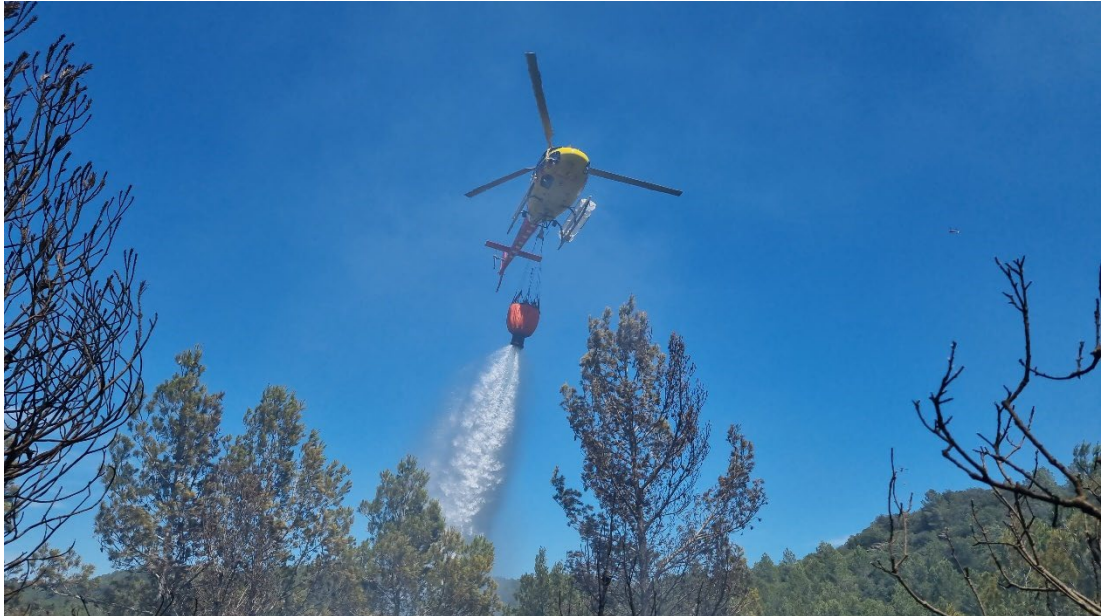
Figuur 2.5 Een blushelikopter van de Catalaanse brandweer loost water vanuit een Bambi Bucket over een natuurbrand
