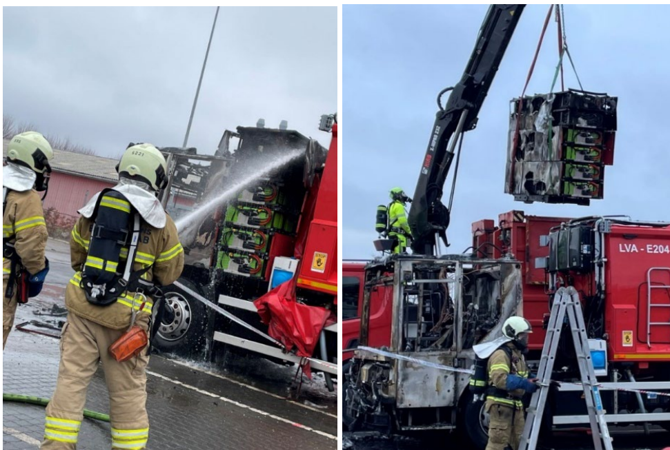
Figuur 4.5: Koelen en demontage van het batterijpakket. (Bron: Facebook post brandweer Kopenhagen )
