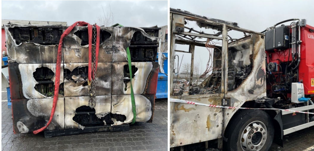
Figuur 4.6: Het batterijpakket na de demontage en de cabine na de inzet. (Bron: Facebook post brandweer Kopenhagen )
