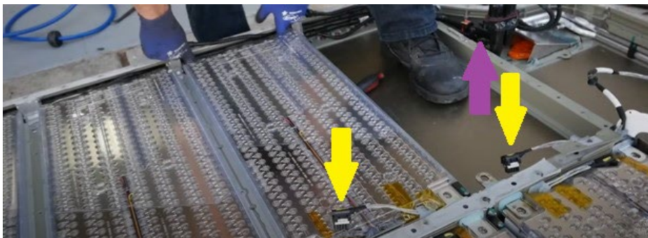
Figuur 4.8 Tesla model S batterijpakket frame (Jehugarcia, 2017)
