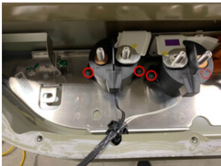
Figuur 4.12 Schakelaar batterijpakket (Tesla, 2024b)
