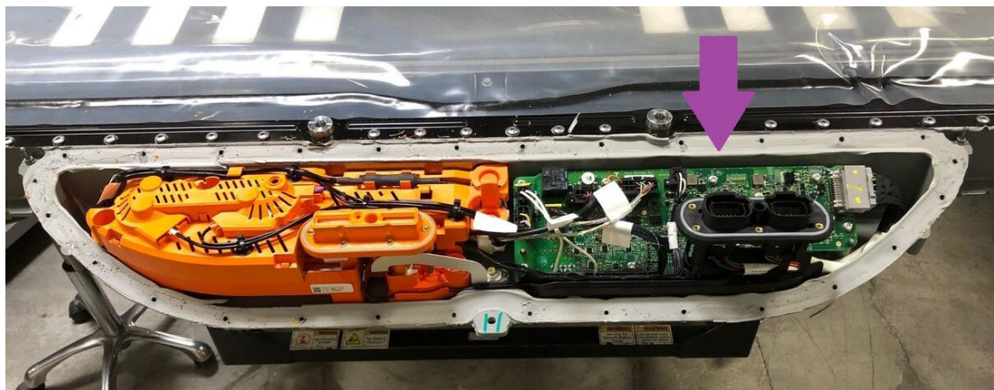
Figuur 4.10 Tesla masterunit (Tesla, 2024a)
