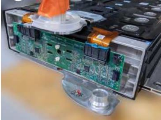
Figuur 4.13 Tesla model 3 module bord (subunit) (Chen, 2023)
