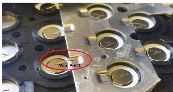
Figuur 4.1 Draadverbinding tussen verschillende cellen (Bhowmick, 2021)
