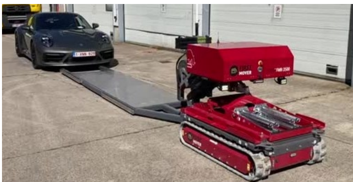
Figuur 3.6 First-mover bergingsrobot met een flatbed (First Mover, 2023).
