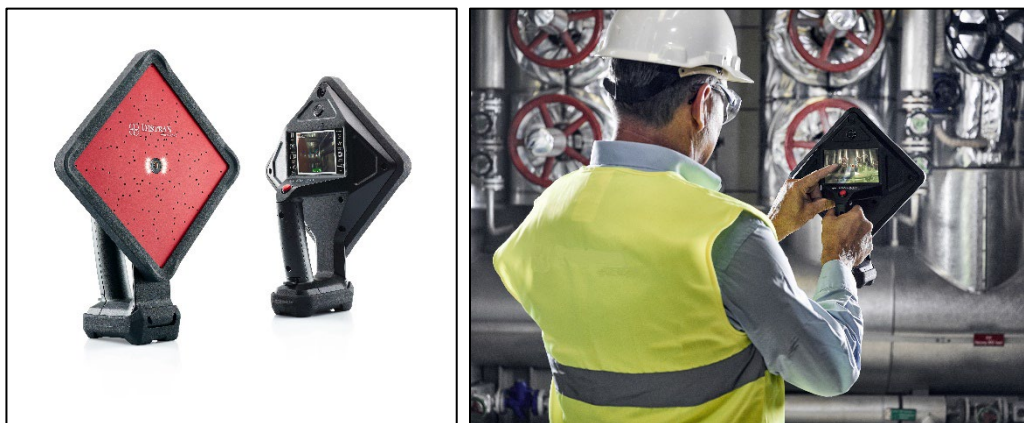
Figuur 3.4 Gebruik van ultrasone camera om waterstoflek te detecteren (Bron: (Distran, z.d.))
