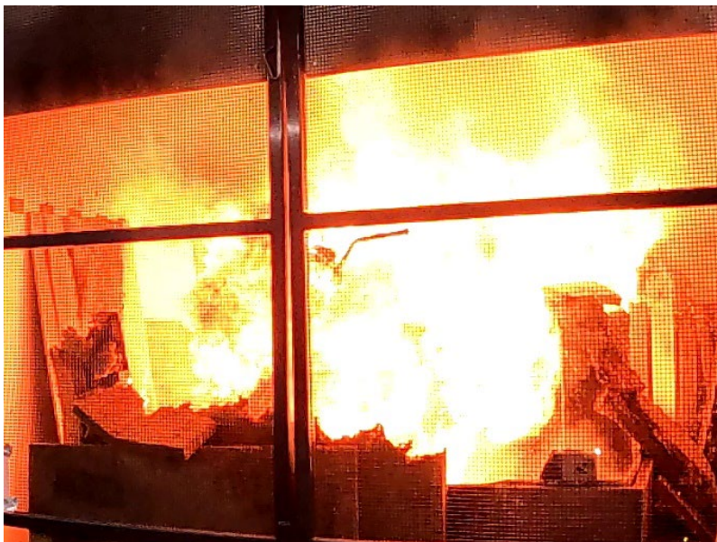
Figuur 2.66 High-end model elektrische scooter met windscherm en topkoffer gedurende de test bij piek brandvermogen (t = 10 minuten)
