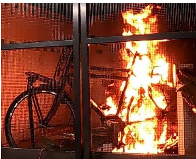
Figuur 2.16 Elektrische fiets zonder accessoires gedurende de test bij piek brandvermogen ( t = 18 minuten)
