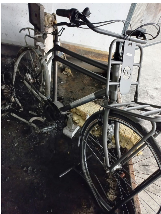
Figuur 2.27 Elektrische fiets met kinderzitje na de test
