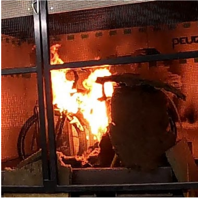
Figuur 2.36 Elektrische fiets met twee accu's gedurende de test bij piek brandvermogen (t = 42 minuten)
