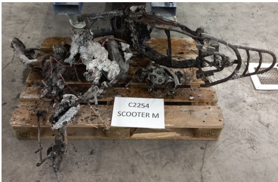
Figuur 2.62 Mid-range model elektrische scooter met windscherm en topkoffer na de test
