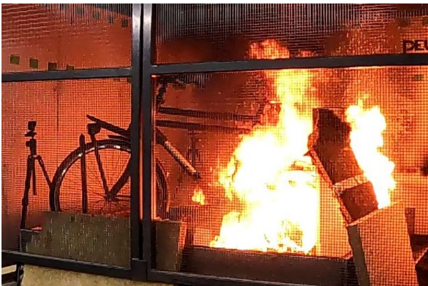
Figuur 2.21 Elektrische fiets met dubbele fietstas gedurende de test bij piek brandvermogen ( t = 8 minuten)
