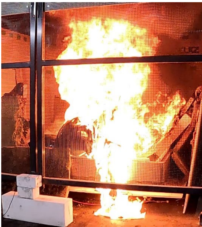
Figuur 2.56 Mid-range model elektrische scooter met windscherm gedurende de test bij piek brandvermogen (t = 7 minuten)
