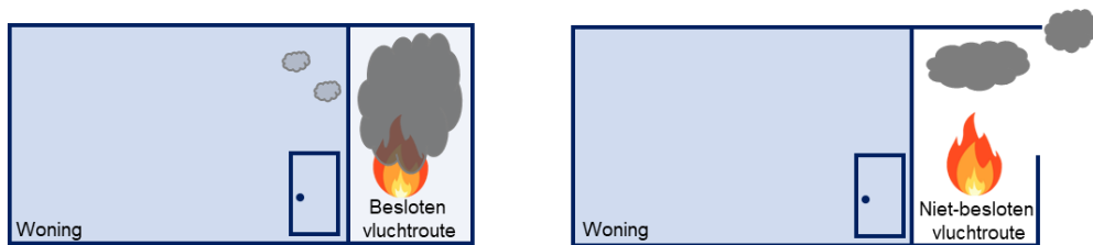
Brand in gemeenschappelijke verkeersruimte
