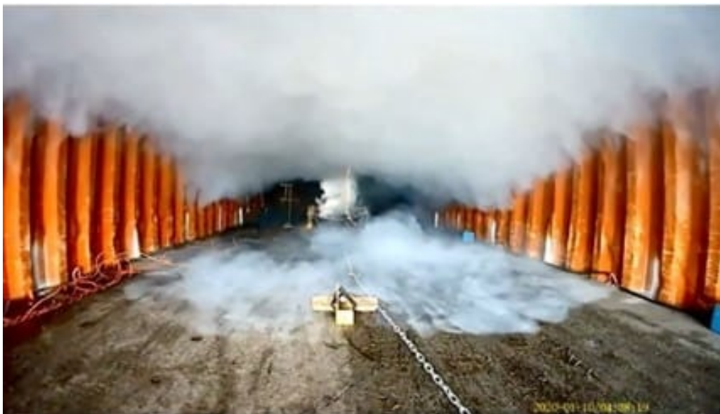
Figuur 1.1 Vrijkomende dampwolk uit 1,7 kWh module (1 minuut en 25 seconden na initiatie van de thermal runaway) (Christensen, 2022)
