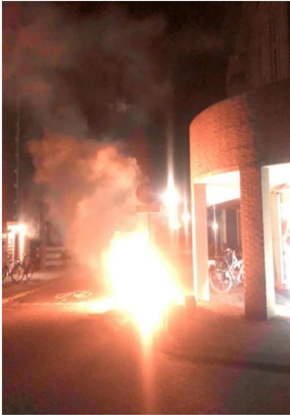
Figuur 3.5 Heftige thermische reactie in één van de ondergedompelde accupakketten
