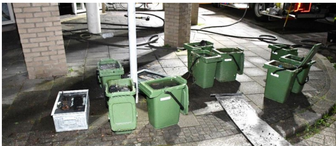
Figuur 3.4 De accupakketten, ondergedompeld in Sulo GFT-afvalcontainers
