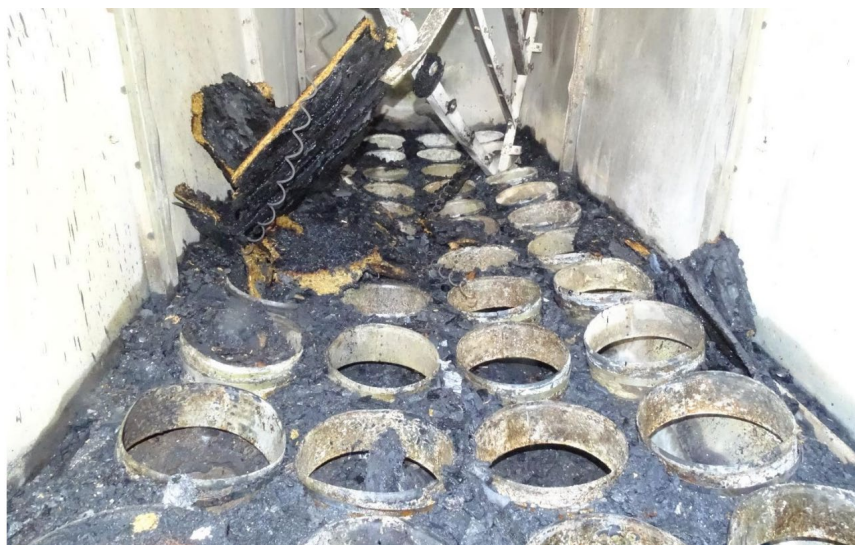
Figuur 2.7 Het grote aantal filterzakken belemmerde het blussen met de sproeischuimblusser
