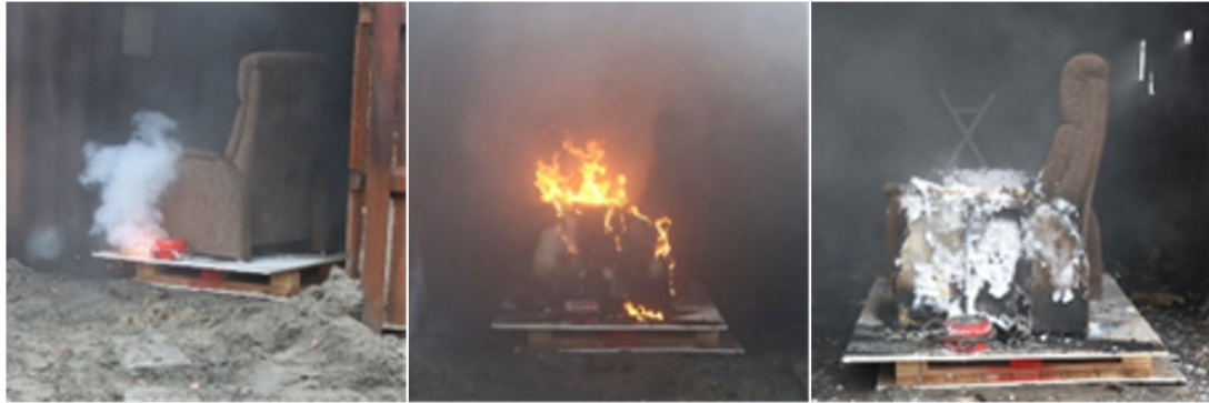
Figuur 4.6 Een zelfonderhoudende brand veroorzaakt door straling van een geactiveerde DSPA generator
