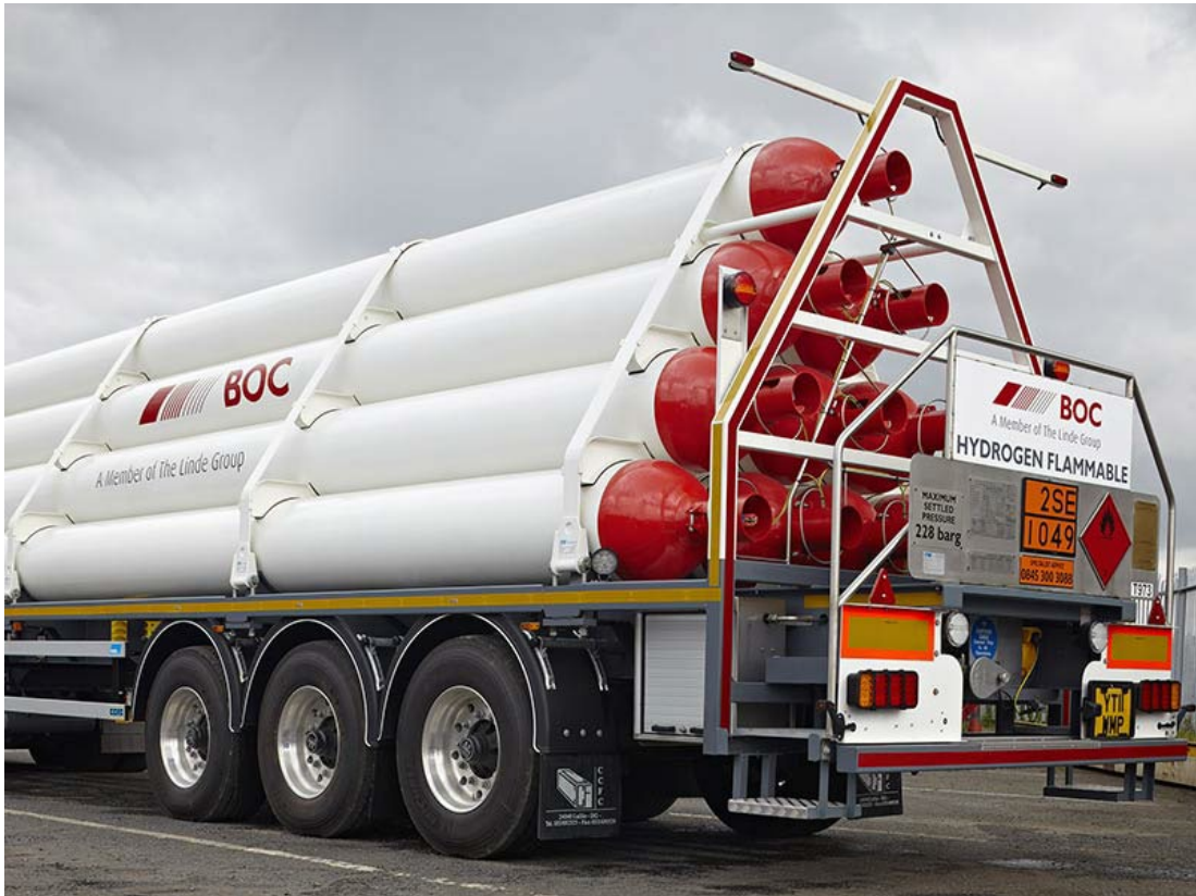
Figuur 1.2 Tubetrailer met waterstof (bron: TIAPM )
