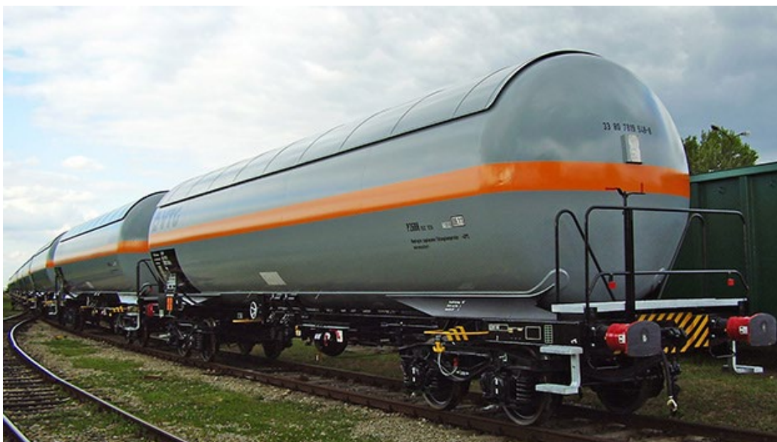
Figuur 1.5 Spooketelwagen voor het transport van tot vloeistof verdicht ammoniak (bron: VTG )
