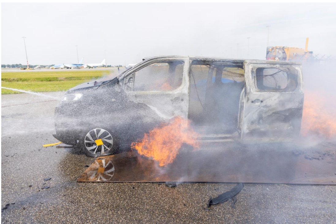
Figuur 5.7 Fakkelt uit batterijpakket (onder de voorste passagiersdeur)
