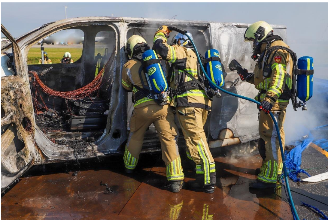
Figuur 5.1 Lokalisatie en monitoren hotspot en gereedmaken voor penetratie
