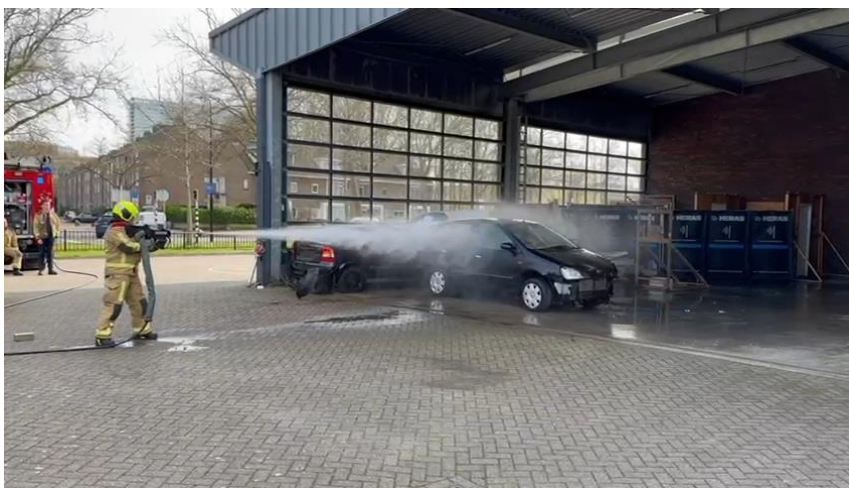
Figuur 4.5 Inzet uhd-blussysteem om ramen kapot te spuiten (foto: Veiligheidsregio Haaglanden)
