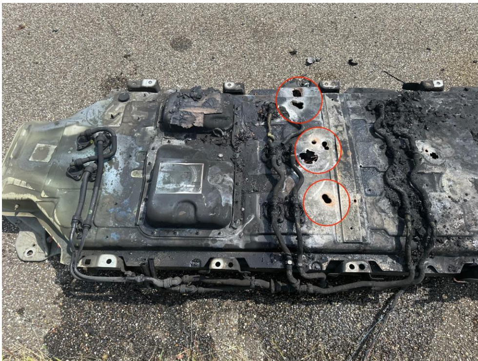
Figuur 5.4 Snijgaten inzet uhd-blussysteem
