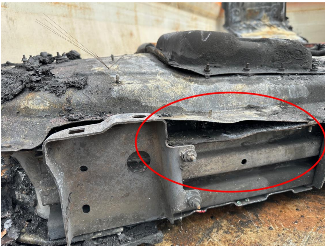
Figuur 5.10 Opening aan de zijkant van het batterijpakket van ca. 4cm
