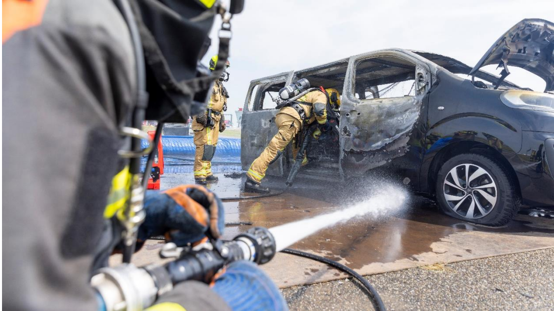
Figuur 5.8 Inzet van de lagedrukstraal om fakkels te doven tijdens de uhd-inzet
