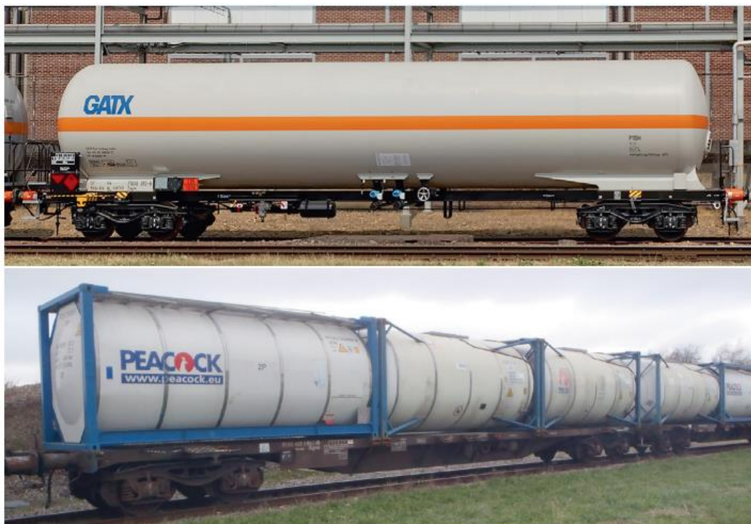
Figuur 3.1 Voorbeelden van een ketelwagen (boven) en een containerwagen (beneden) (Onderzoeksraad voor Veiligheid, 2016)
