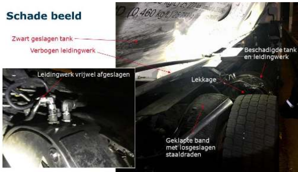
Afbeelding 4.2 Beeld van de lekkende LNG-tank (foto: Veiligheidsregio Zuid-Holland Zuid)
