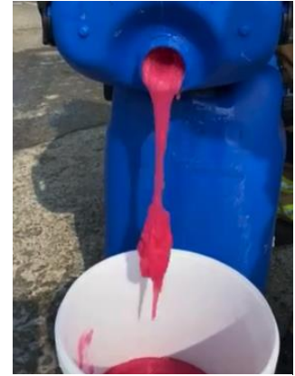
Koud schuimconcentraat wordt hoog viskeus. © H2K
