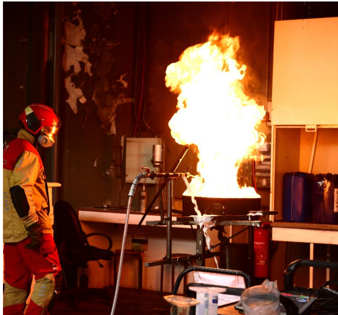
Figuur 3; kleinschalige blustest met blusschuim
