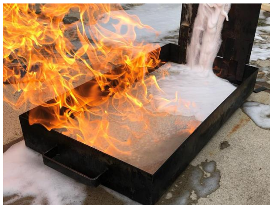
Figuur 2; testopstelling met zachte applicatie
