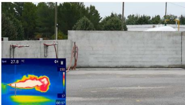
Foto 1: fakkelbrand waterstof alleen zichtbaar met WBC, stralingswarmte neemt rondom vlam sterk af.
