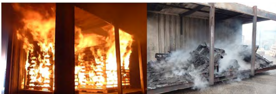
Figuur 2-10. De vuurhaard voor de start van één van de experimenten (links) en restanten van de vuurhaard na het einde van één van de experimenten (rechts)
