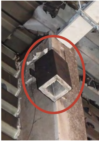
Figuur 2-7. Afscherming thermokoppels
