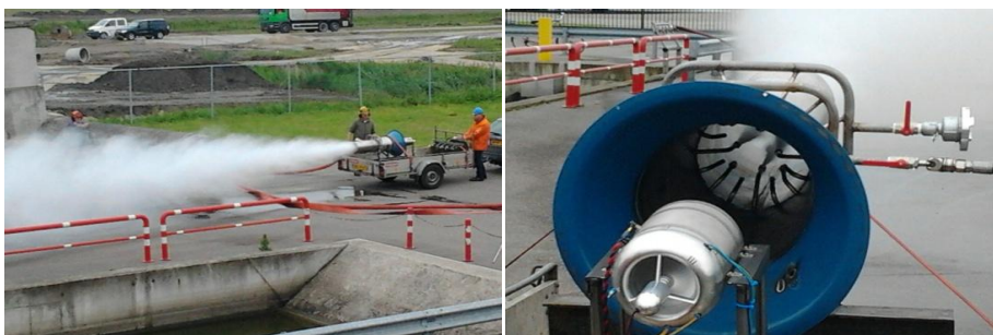
Figuur 5 Verneveling van water door Microturbine
