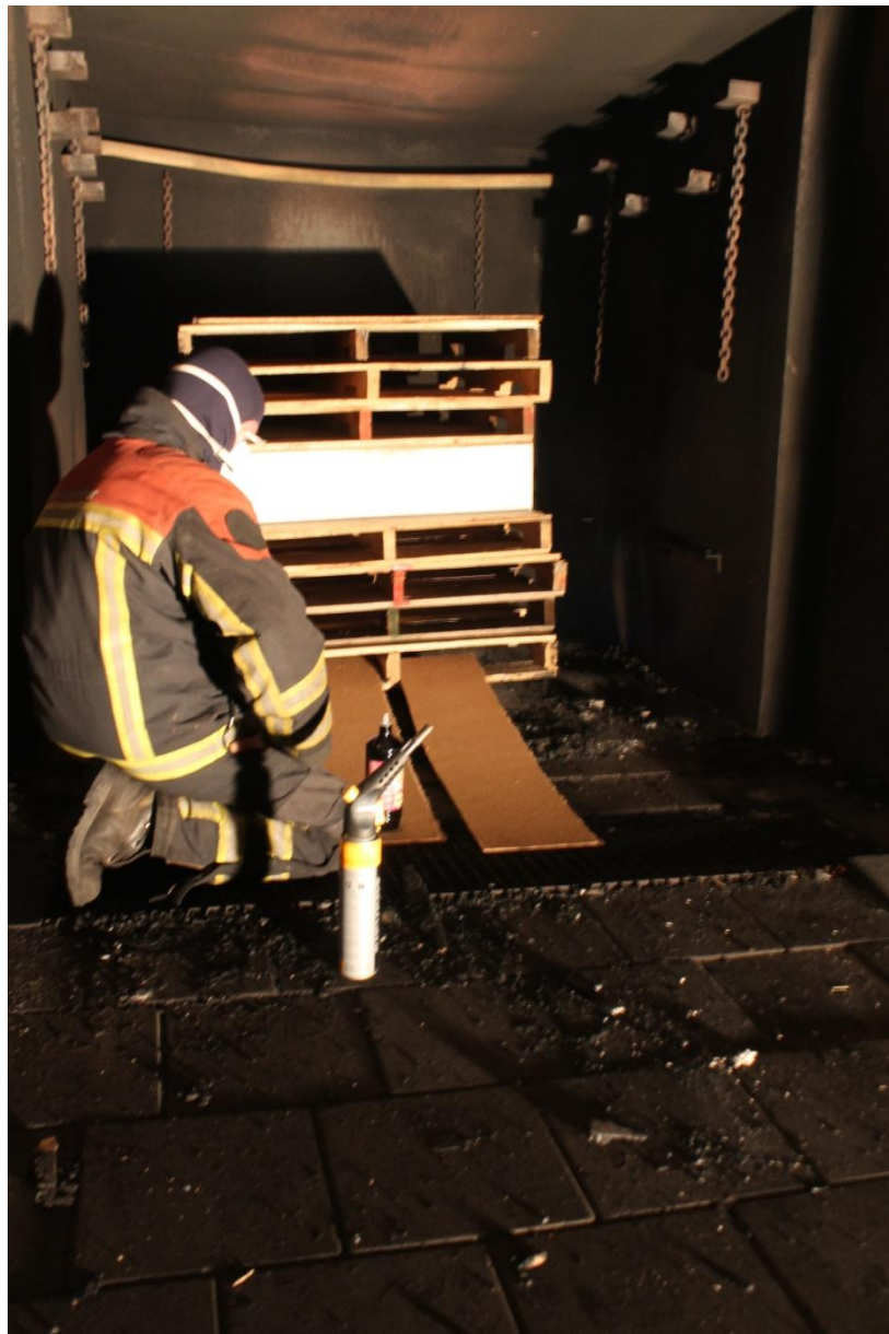
Afbeelding 3.2: Opbouw en aansteken vuurlast
