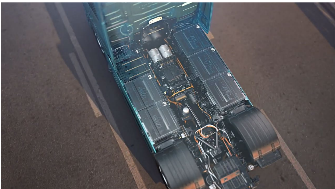
Figuur 2.3 Batterijpakketten in (Volvo) vrachtwagen (bron: Volvo 2023)
