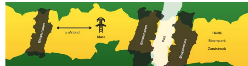
Afbeelding 19: Brandgang met brandremmende maatregelen, Tennet
