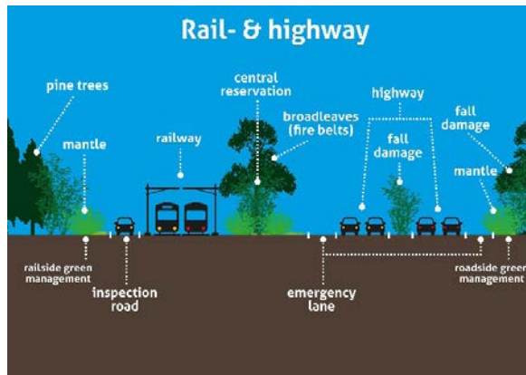
Afbeelding 22: Brandgang trein-snelweg, IENE
