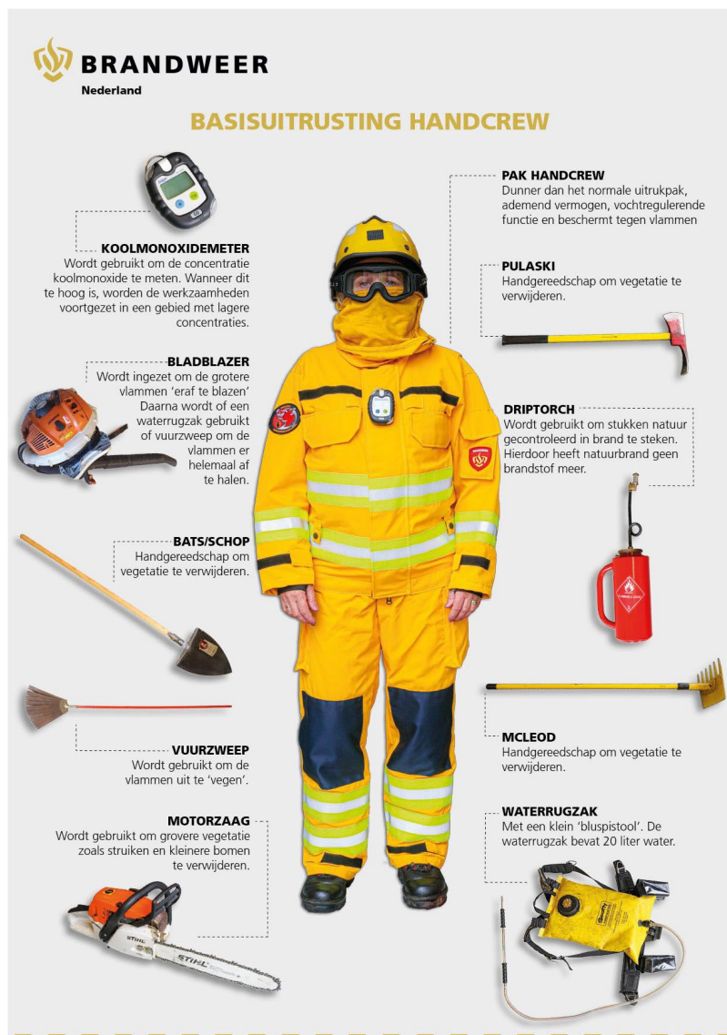
Figuur 2.13 Een overzicht van de basisuitrusting van de handcrew (Bron: Brandweer Nederland)
