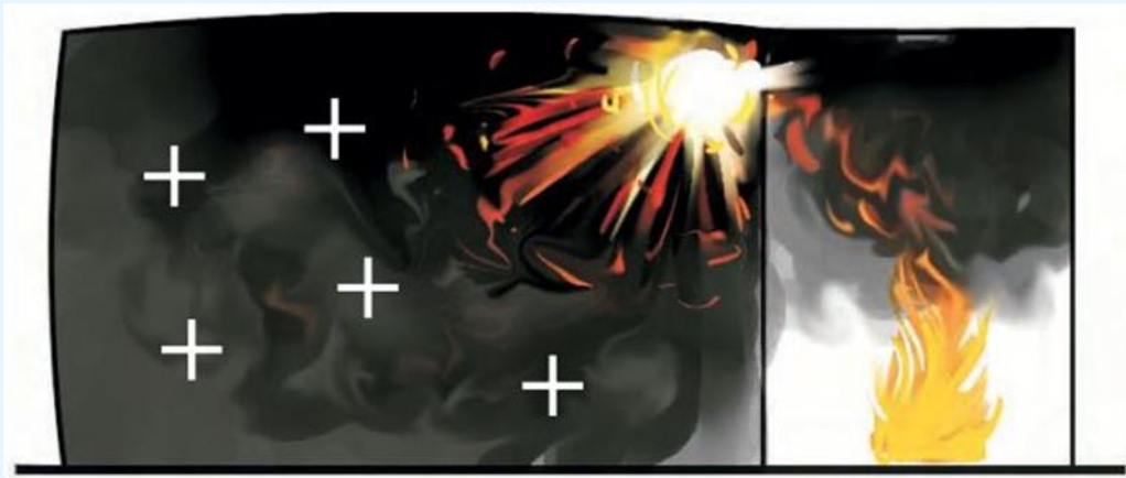
figuur 4: Een rookgasexplosie in een ruimte grenzend aan de brandruimte. Onvolledig verbrande ontledingsgassen uit de brandruimte zijn naar de aangrenzende ruimte gelekt en ontsteken als een brandend deeltje of een vlam door de lekopening komt. Bron: [BENG2001, blz.151]
