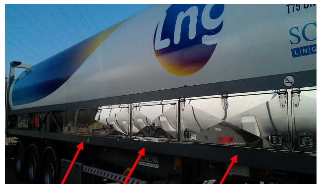
LNG-tankwagen, met bedieningskast aan zijkant
