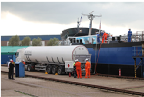
Mobiële bunkerlocatie vanaf tankwagens
