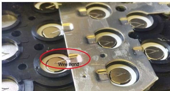
Figuur 4.1 Draadverbinding tussen verschillende cellen (Bhowmick, 2021)
