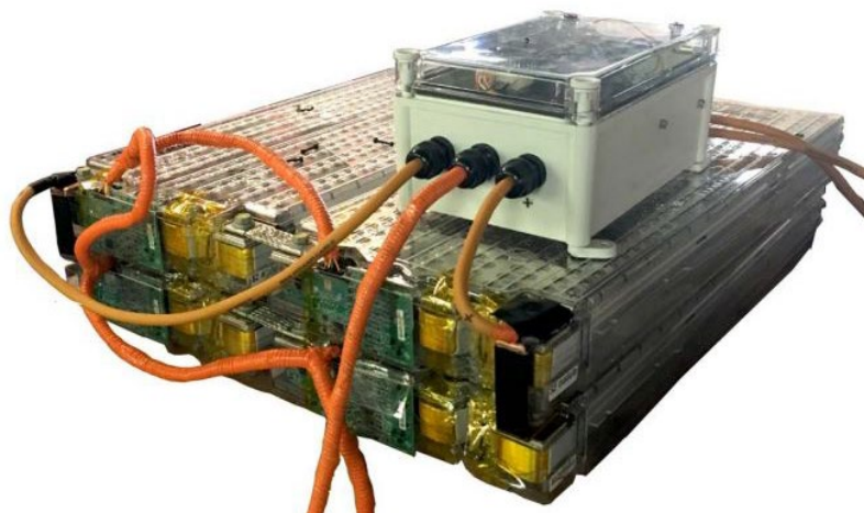
Figuur 4.17 EVTV monitor/controller voor batterijpakketten die zijn opgebouwd uit eerste generatie Tesla-batterijen (SCRIBD, 2017)
