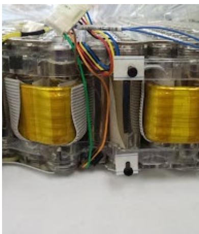
Figuur 4.4 Draden voor stroom- en spanningsmonitoring (William, 2016a)
