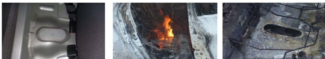
Afbeelding 2.12 Brandweer vulopening in een Renault ZoE voor, tijdens en na een brandtest (Petit Boulanger et al., 2016)
