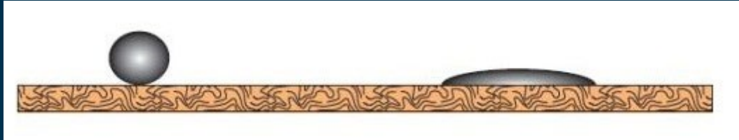
Figuur 2: Door toevoeging van een surfactant wordt de oppervlakte spanning van water lager, waardoor het indringend vermogen groter is. (Bron: ITRC, 2015)
