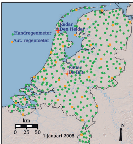
FIGUUR 1 DE LOCATIES VAN DE 33 AUTOMATISCHE REGENMETERS (ORANJE VIERKANTEN), DE 326 HANDREGENMETERS (GROENE CIRKELS) EN DE 2 WEERRADARS (RODE KRUIZEN) VAN HET KNMI OP 1 JANUARI 2008
