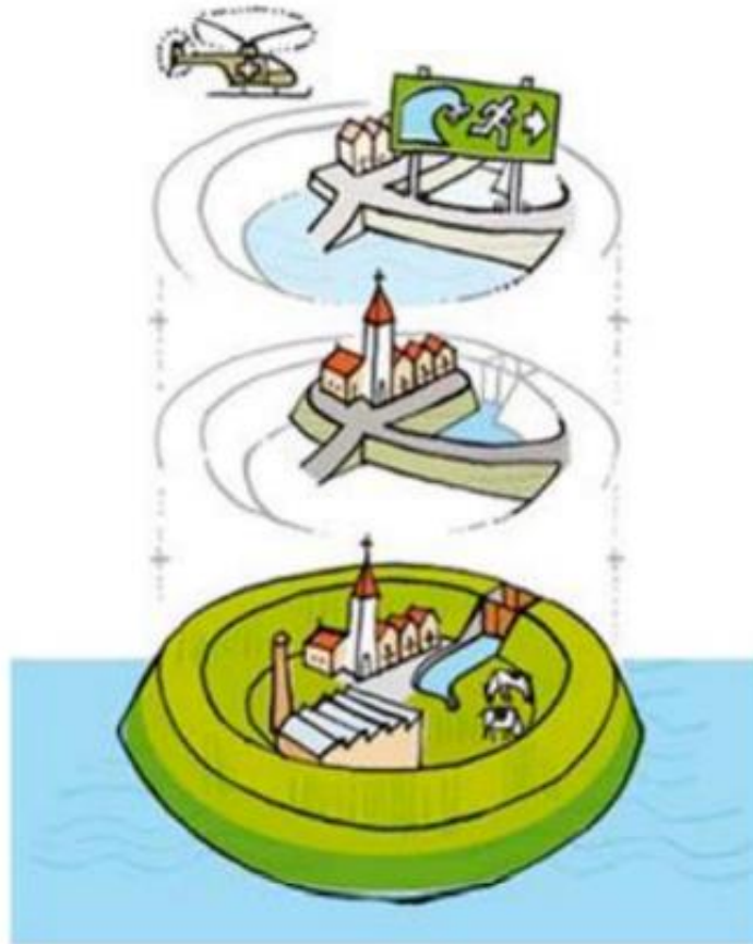
Figuur 5: “Meerlaagsveiligheid draait om het samenspel van maatregelen in laag 1 (preventie), laag 2 (ruimtelijke inrichting) en laag 3 (rampenbeheersing)” (Wing, 2013).
