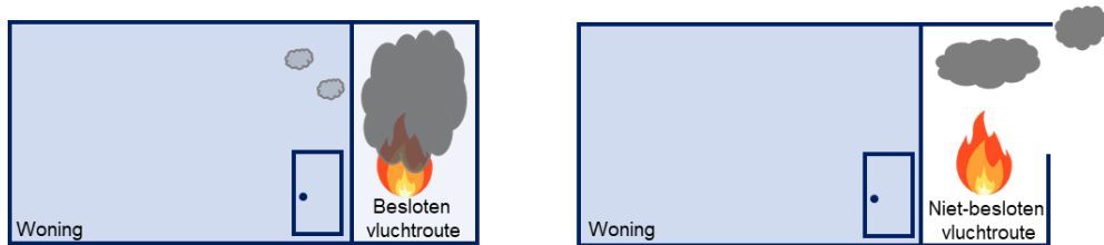
Brand in gemeenschappelijke verkeersruimte
