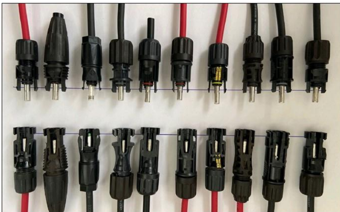
Figuur 4.1 Zonnepaneelconnectoren die in naam compatibel zijn. De foto laat echter zien dat er onderling verschillen zijn. (foto: Tom van den Oetelaar, IZEN)
