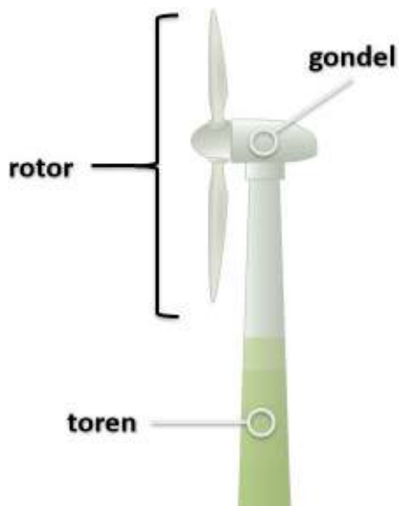
Figuur 1.1 Schematische impressie van een windturbine
