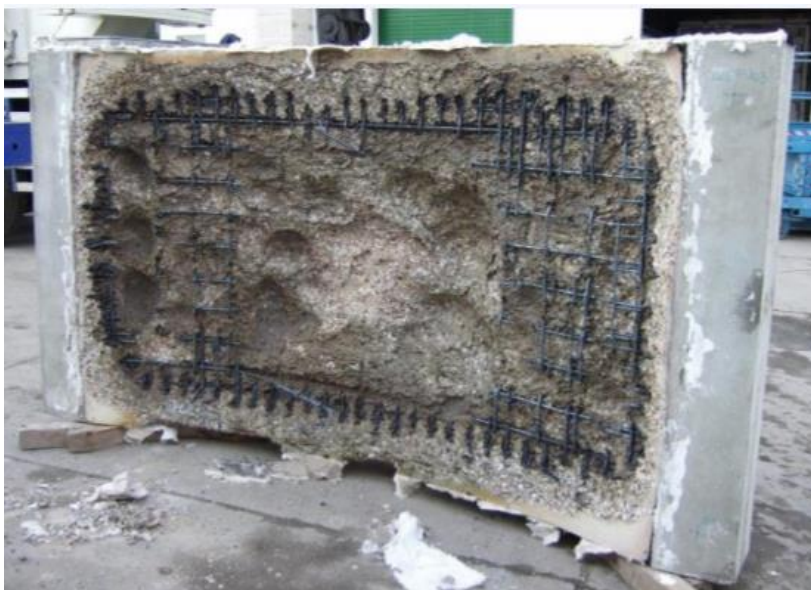
Afbeelding B 1.2 : Blootliggende wapening. Foto: MFPA Leipzig GmbH
