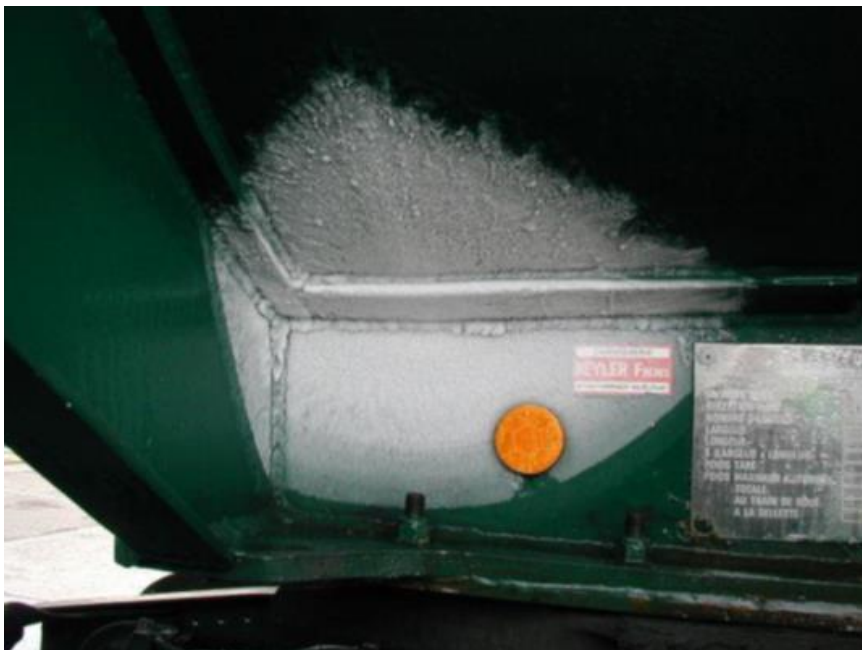
Afbeelding 8: Bevroeringsverschijnselen van LNG als gevolg van kapotte isolatie.
