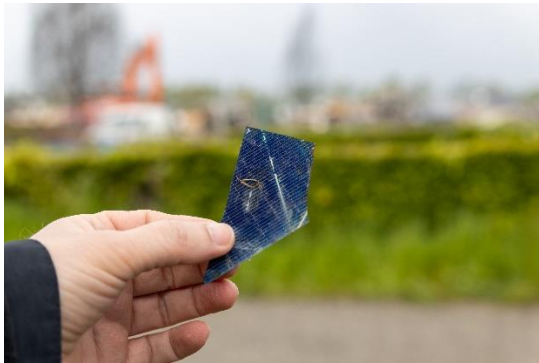
Afbeelding I.1 Een zonnecelscherf, gevonden bij een brand met depositie van resten van zonnepanelen (bron: CAMJO Media)
