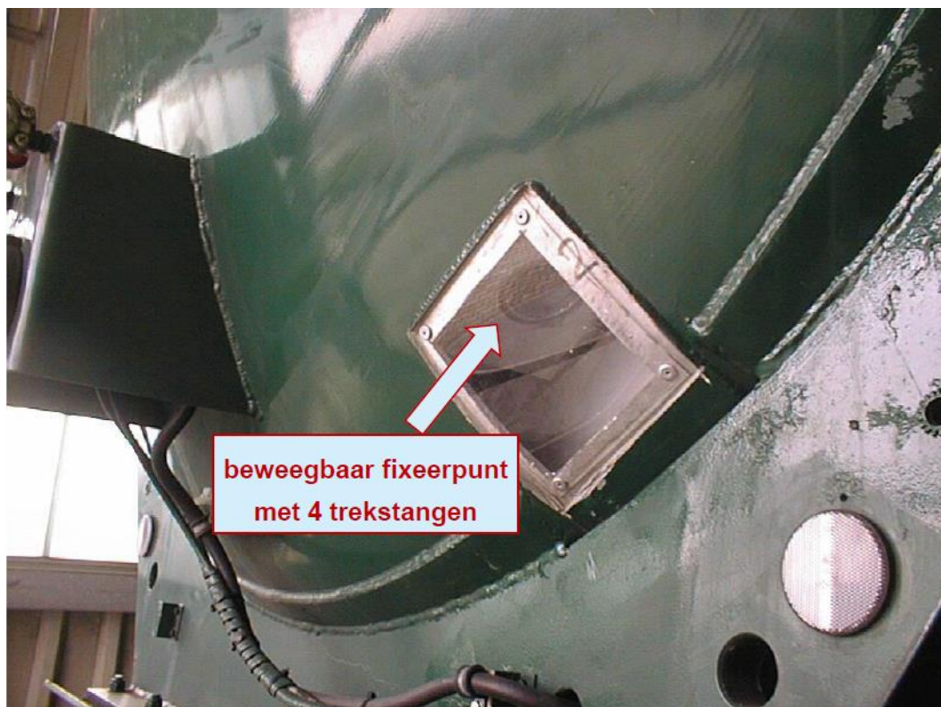
Afbeelding B2.9 In deze tankwagen is voor oefendoeleinden het fixeerpunt zichtbaar gemaakt
