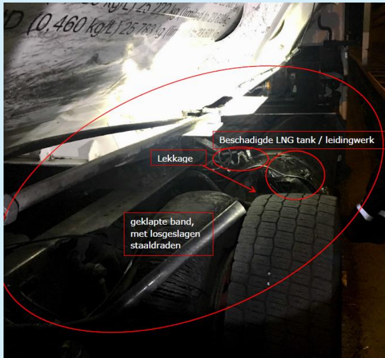
Afbeelding 6.2 Schade bij LNG-tank (B. van Bommel)
