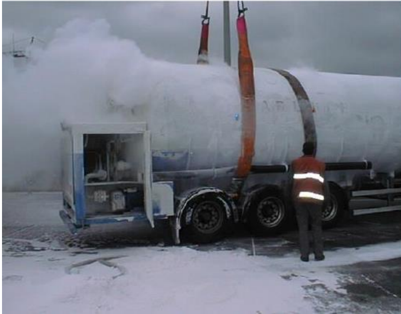
Afbeelding B2.13 Vrijkomen van perliet (wit poeder op de grond) en snel verdampende vloeibare fase (vormen van witte nevel) van een cryogeen gas
