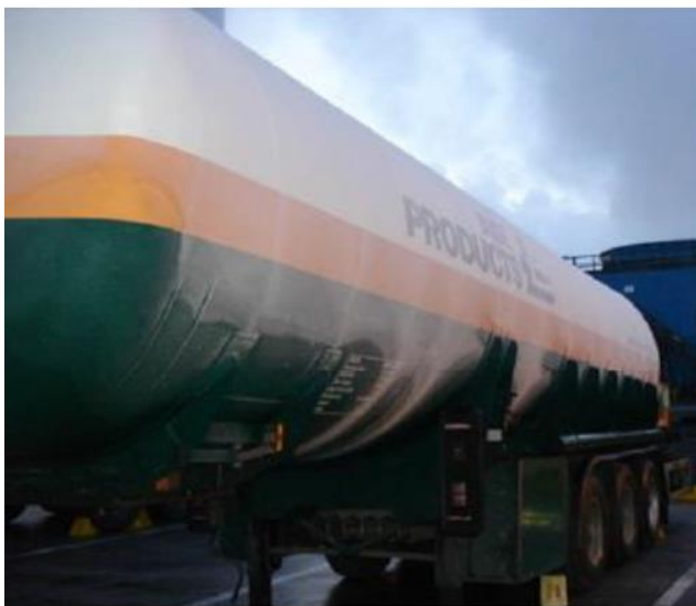
Afbeelding B2.12 Beschadiging isolatie is te herkennen aan ijsvorming aan de buitenkant
