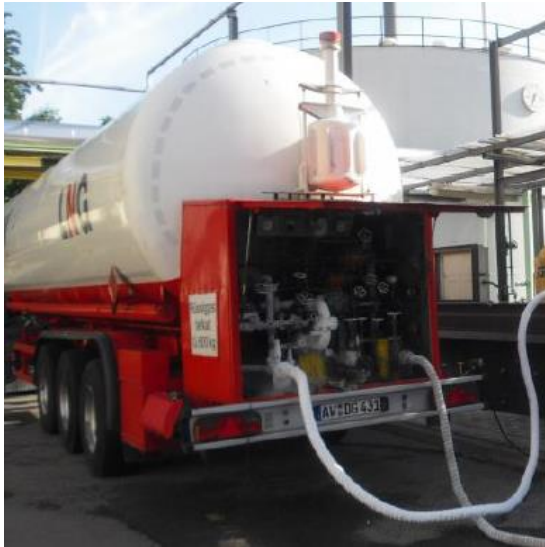
Afbeelding B2.3 LNG-tankwagen met bedieningskast achterop
