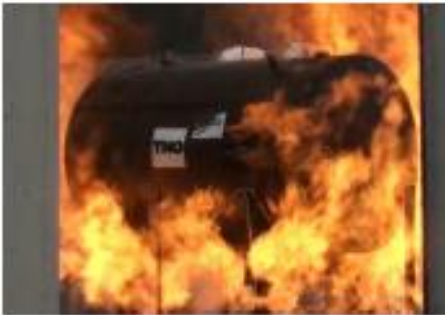
Afbeelding 5.3 Foto test LNG-tank bij BAM (TNO)
