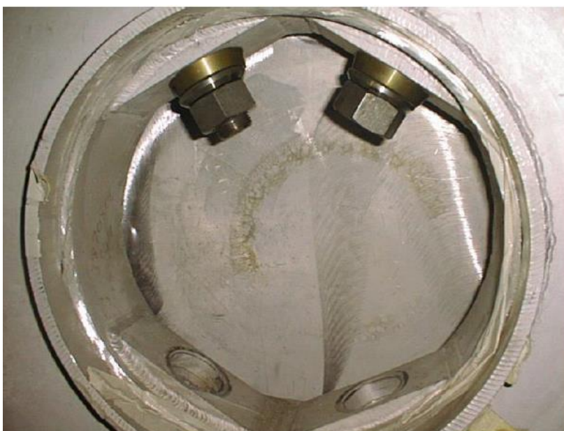
Afbeelding B2.10 Vergroting van het fixeerpunt met bevestiging van de bovenste twee trekstangen; in de normale situatie zijn er vier trekstangen bevestigd
