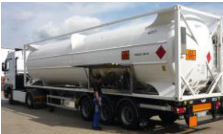
Afbeelding B2.4 LNG-tankcontainer op trailer met bedieningskast aan de zijkant
