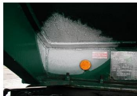
Afbeelding B2.12 Beschadiging isolatie is te herkennen aan ijsvorming aan de buitenkant
