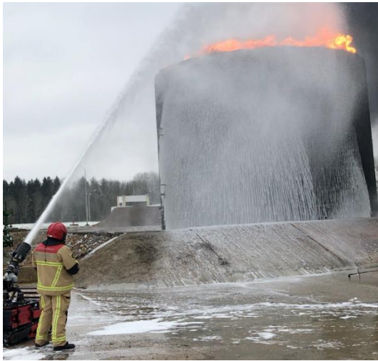
Figuur 3; oefening blussing tankbrand met fluorvrij schuim
