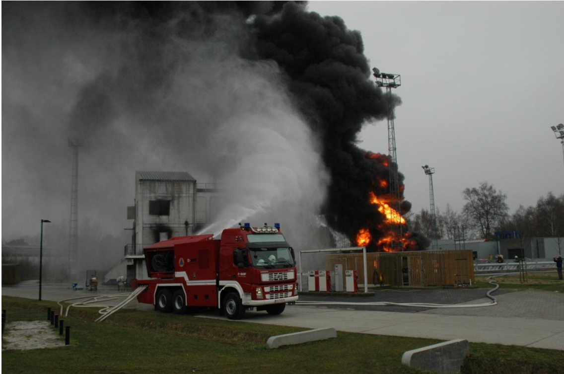
Figuur 14 De waternevel wordt afgebogen door de turbulentie van de rookkolom en door de wind
