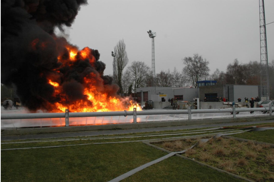
Figuur 13 Het effect van het aanwakkeren met de Microturbine is alleen boven de eerste paar meter van de bak zichtbaar
