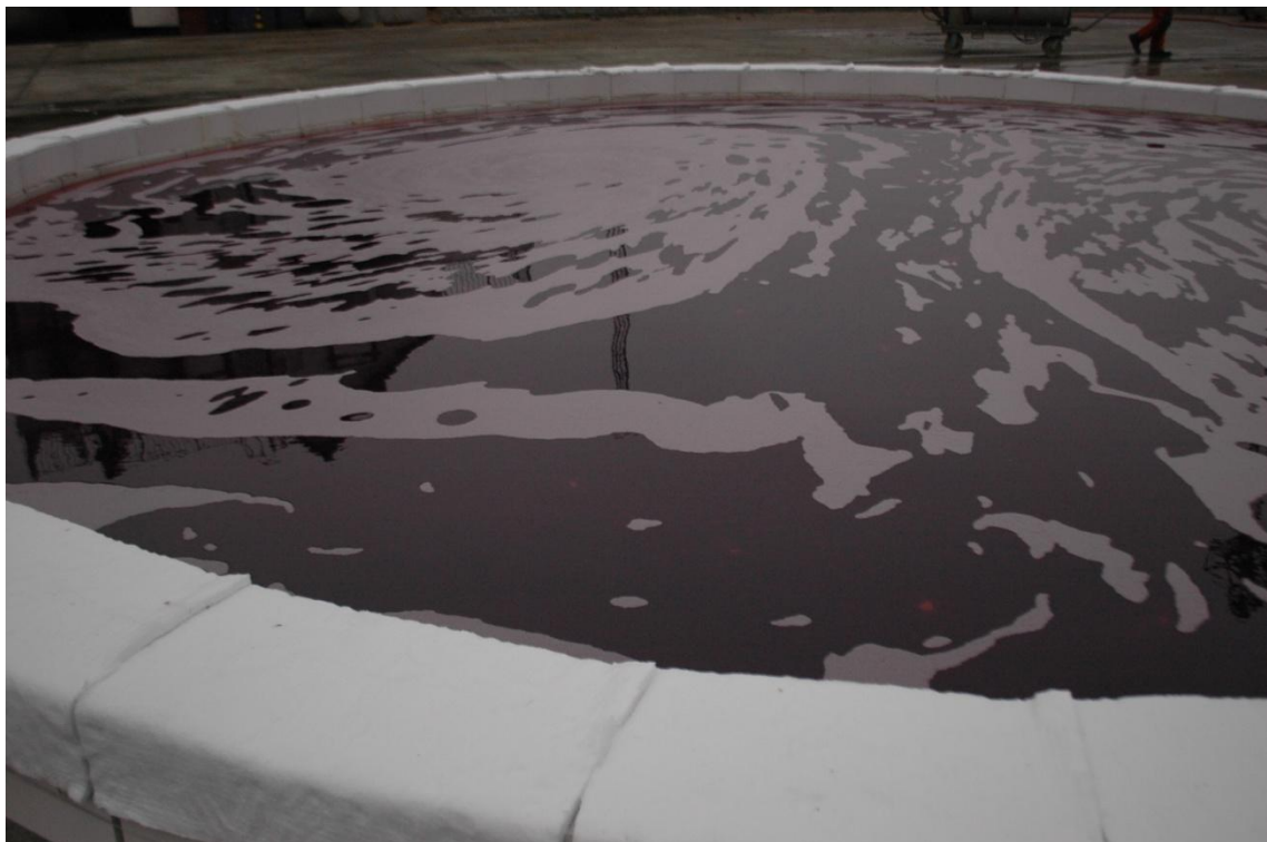
Figuur 3 De brandstof op een laag water, 150-250 mm onder de rand van de bak
