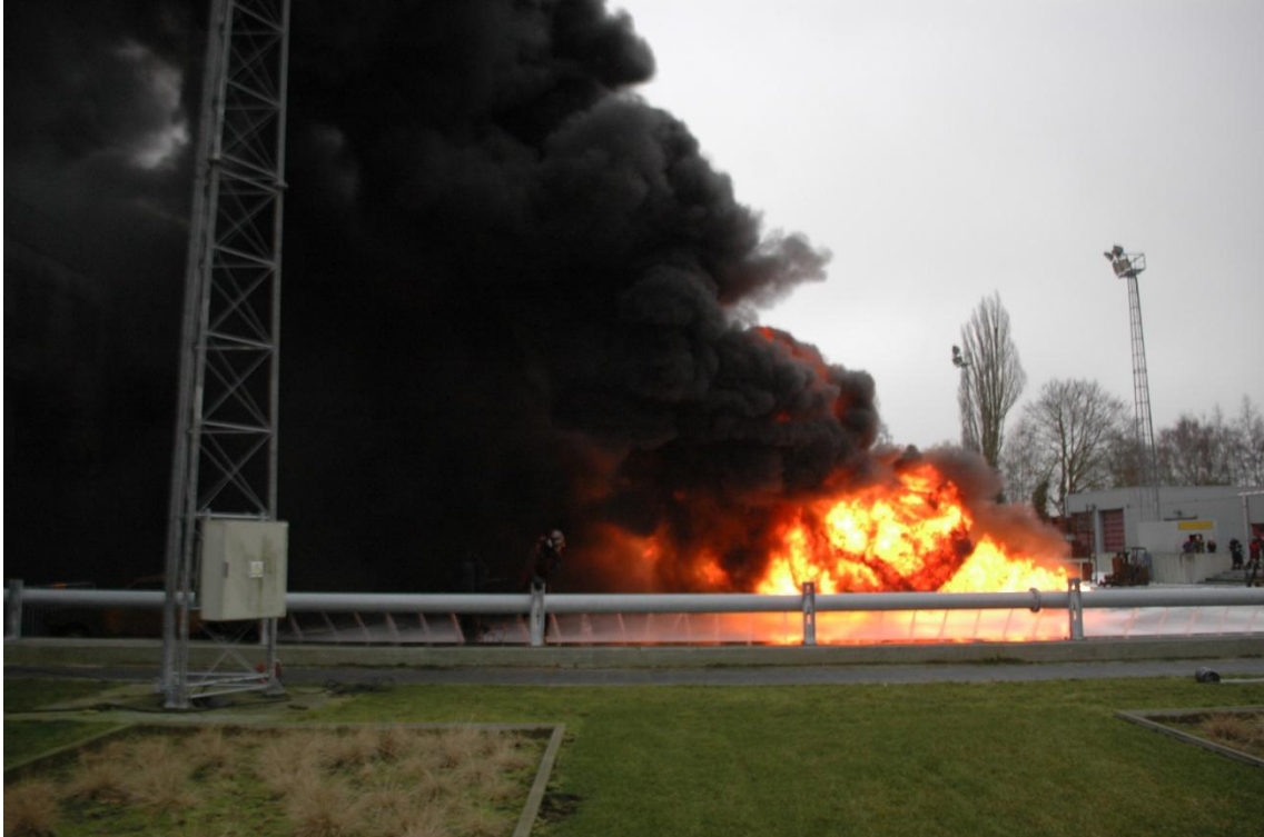
Figuur 12 Bij het aanwakkeren van de brand met de Turbo Löscher is de invloed met name boven de voorste helft van de bak zichtbaar
