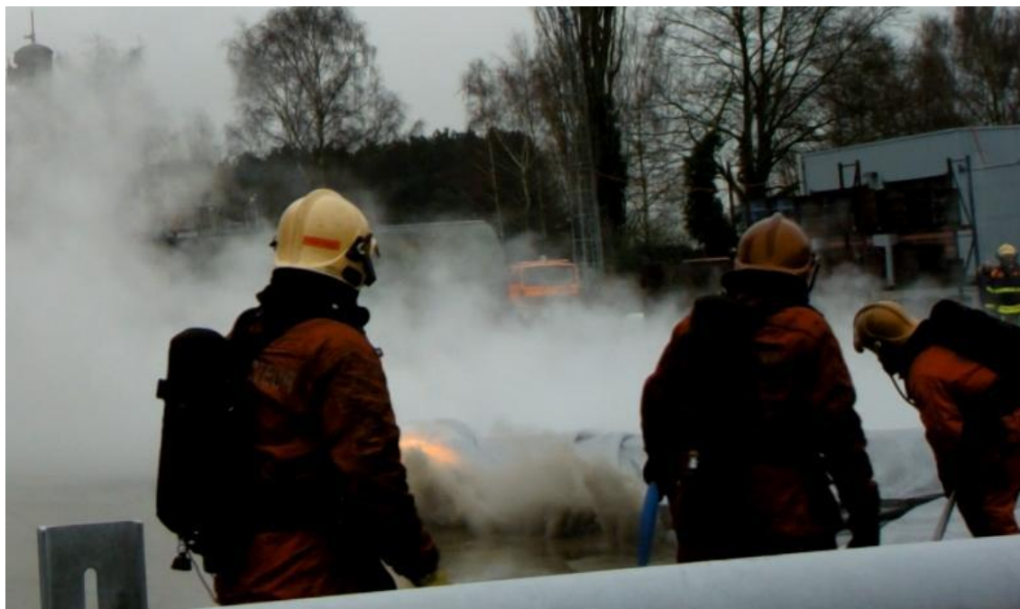
Figuur 16 Gassen die van onder de blusdeken ontsnappen herontsteken dicht bij het brandweerpersonnel
