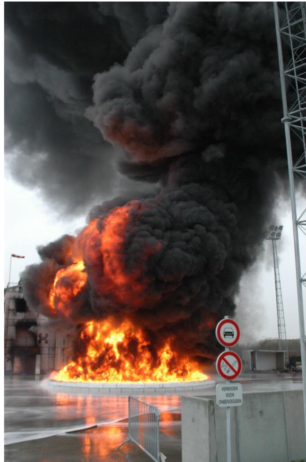
Figuur 15 Door de turbinestraal in de rookkolom ontstaat een groter brandvermogen
