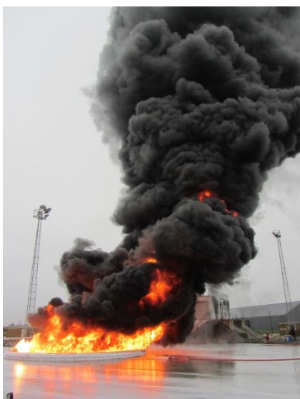
Figuur 1 De ronde bak met brandende diesel tijdens een van de experimenten
