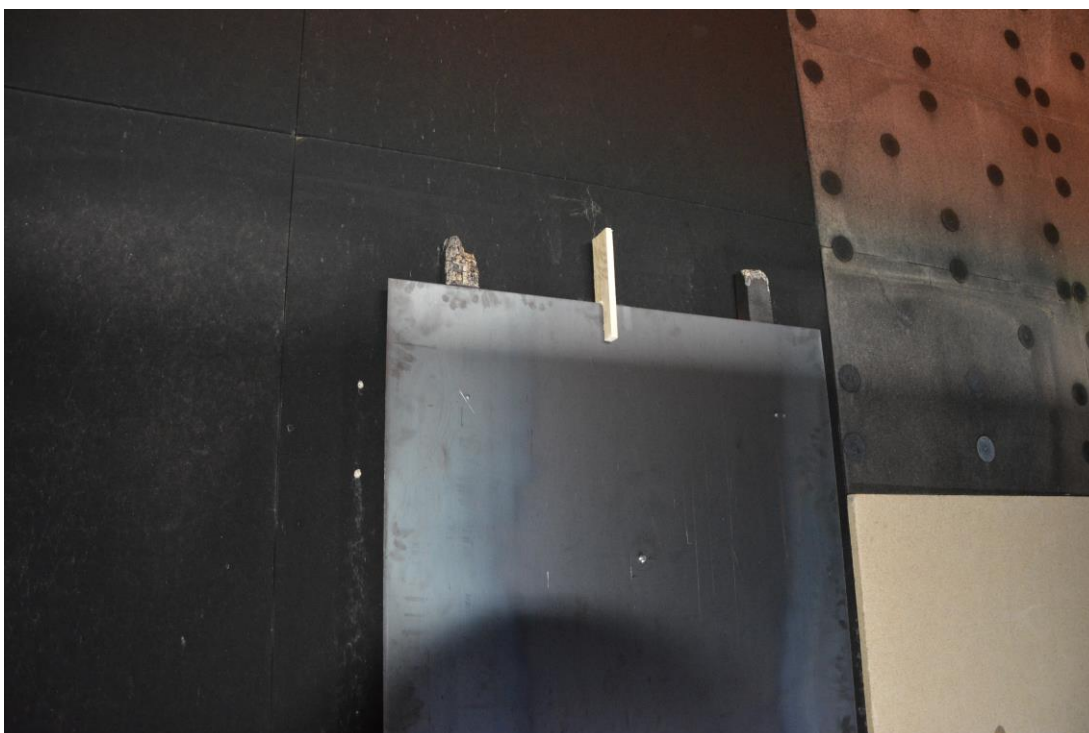
Figuur 10 Staalplaat ('ontvangende wand')
