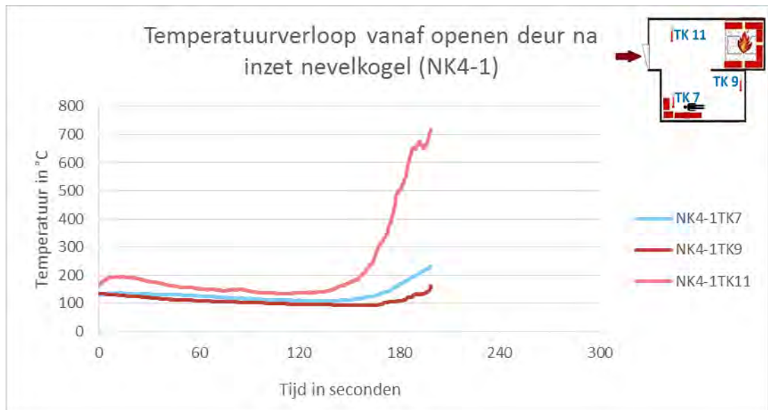
Figuur 3-37. Temperatuurverloop vanaf openen deur na inzet NK (NK4-1)
