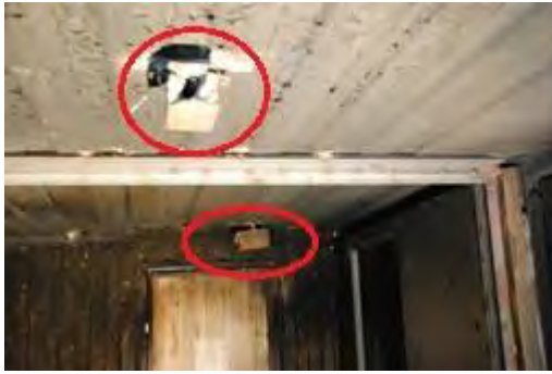
Figuur 2-4. Afscherming thermokoppels
