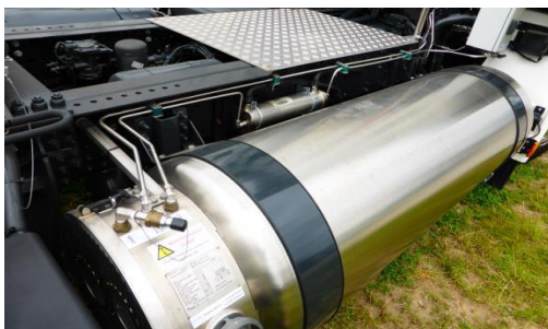
Afbeelding 7.4 LNG-brandstoftank: rechts bij 1: aansluiting voor LNG-slang (tanken); 2: drukontlasting voor tanken; 3: leiding richting afblaaspijp; 4: leiding richting motor
