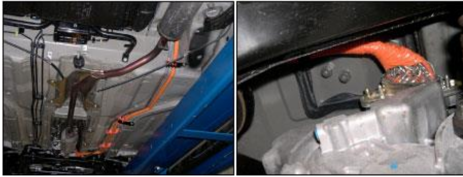
Afbeelding 5.4 Hoog voltagekabels onder de bodemplaat van hybride personenvoertuigen
