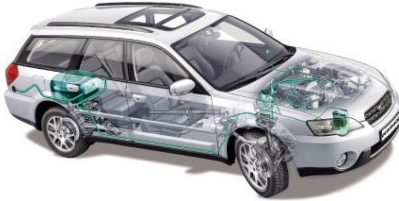
Afbeelding 6.2 Personenvoertuig met LPG als brandstof. In de bagageruimte is de tank ingebouwd in het reservewielcompartiment
