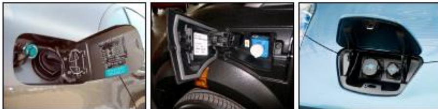
Afbeelding 4.6 Verschillende tankdoppen: bivalent benzine/aardgas (links), elektrisch voertuig, laadstekker in spatbord (midden) en elektrisch voertuig met twee laadstekkers aan de voorzijde (rechts)
