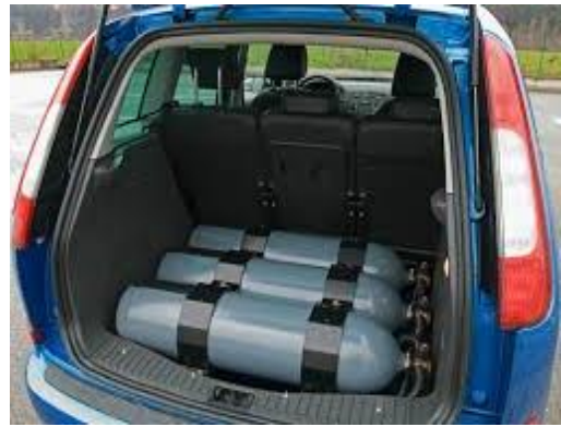
Afbeelding 7.3 Personenvoertuig op aardgas, Volkswagen Touran Ecofuel en later ingebouwd in de kofferruimte
