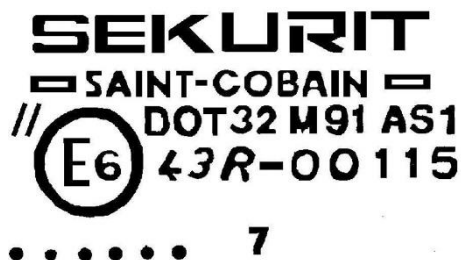
Afbeelding 3.9 Herkenningsteken gelaagde beglazing (te herkennen aan de twee diagonale streepjes), bij niet-gelaagde beglazing zijn deze streepjes niet aanwezig
