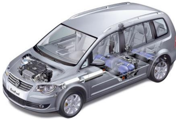
Afbeelding 7.3 Personenvoertuig op aardgas, Volkswagen Touran Ecofuel en later ingebouwd in de kofferruimte
