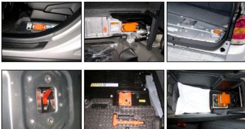
Afbeelding 5.6 Voorbeelden van onderhoudstekkers van verschillende personenvoertuigen
