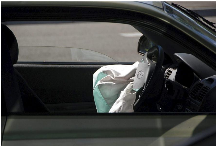
Afbeelding 3.4 Geactiveerde, leeggelopen airbag
