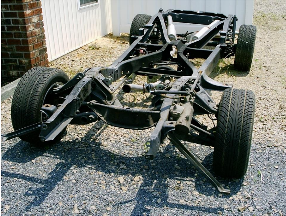
Afbeelding 2.2 Een chassis (met wielophanging en uitlaatsysteem)
