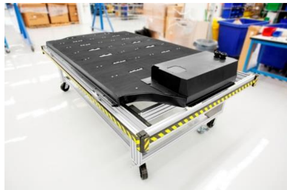
Afbeelding 5.5 Tesla Motors – Model S Li-ion accupack
