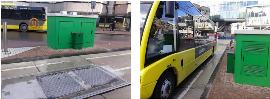
Afbeelding B4.5 Inductief opgeladen bus in Utrecht
