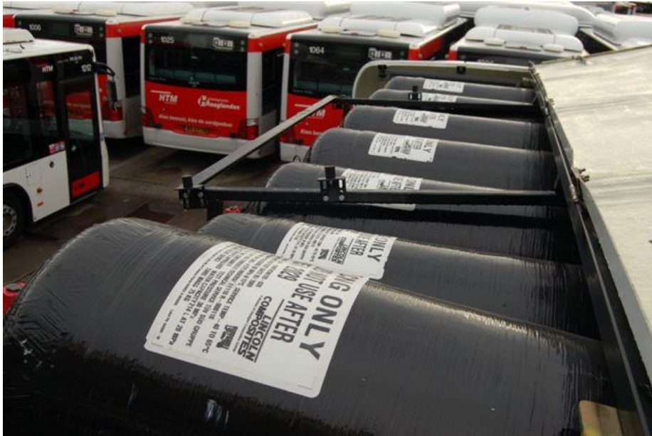
Afbeelding 7.2 CNG-tanks op het dak van een bus
