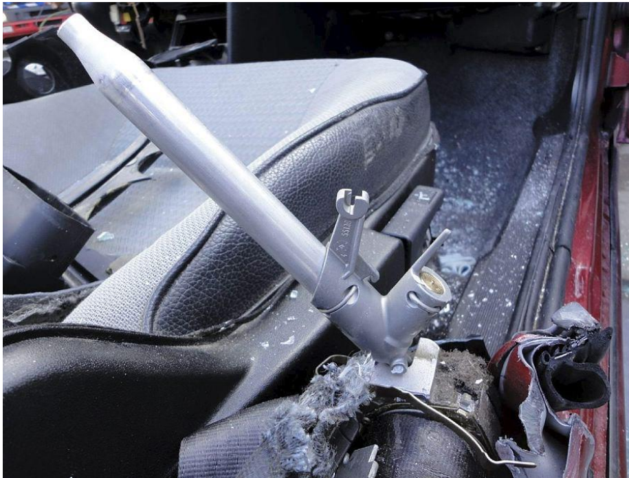
Afbeelding 3.1 Gordel met pyrotechnische gordelspanners
