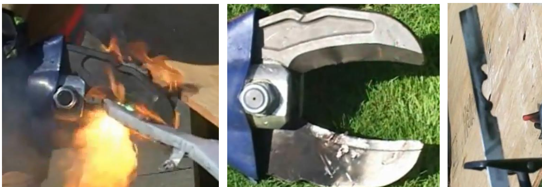
Afbeelding 4.10 Effect op de bek van een schaar en een reciproczaag bij het doorknippen/zagen van oranje high power kabels
