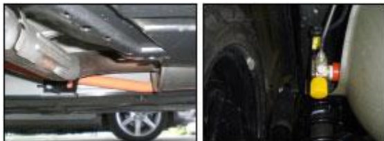
Afbeelding 4.5 Blik onder het voertuig: hoogvoltagekabel (links) en gastank (rechts)
