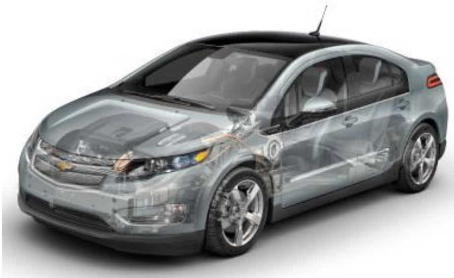
Afbeelding 9.7 Chevrolet Volt, elektrisch personenvoertuig met range-extender
