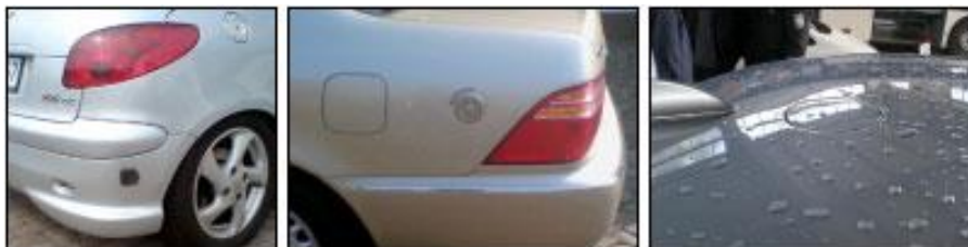
Afbeelding 4.7 Voorbeelden van extra tankdoppen en overige ongebruikelijke openingen
