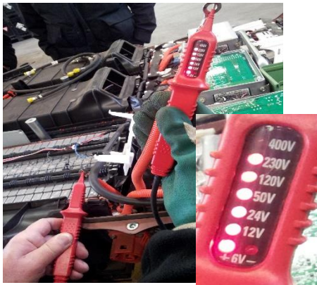
Afbeelding 4.13 Opengewerkte accu van bus geeft spanning van 230 V
