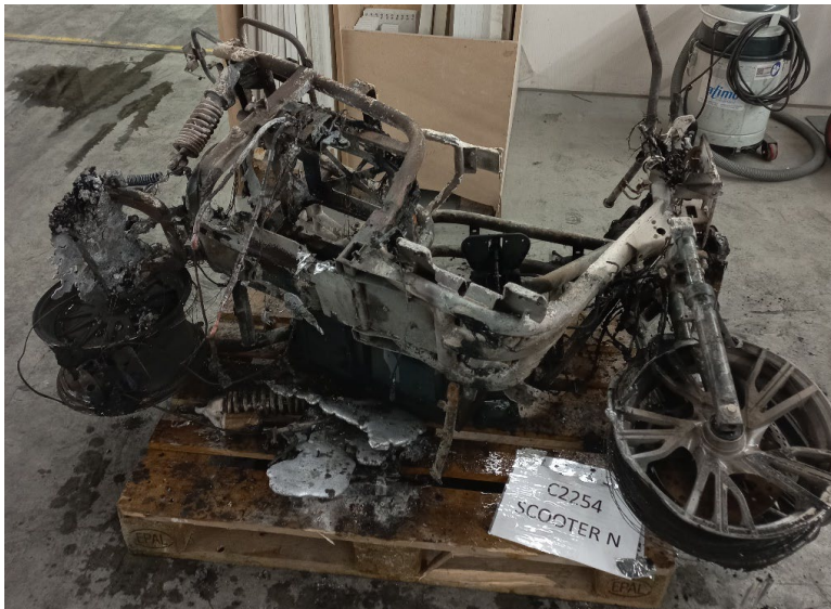
Figuur 2.67 High-end model elektrische scooter met windscherm en topkoffer na de test
