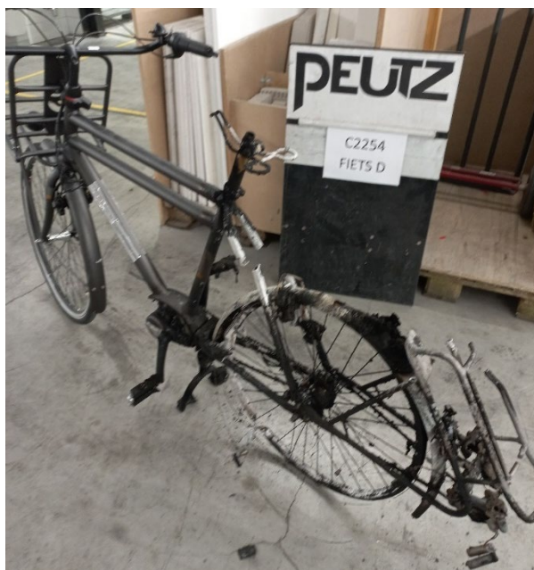
Figuur 2.17 Elektrische fiets zonder accessoires na de test
