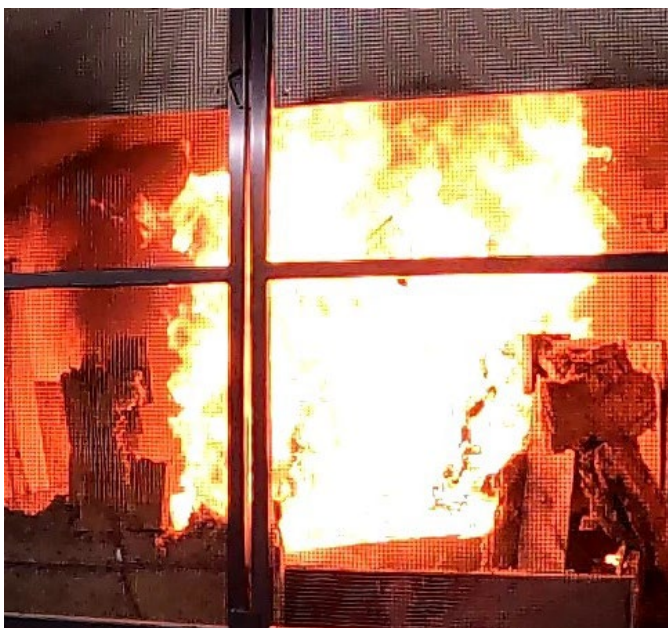
Figuur 2.41 Benzinescooter gedurende de test bij piek brandvermogen ( t = 5 minuten)
