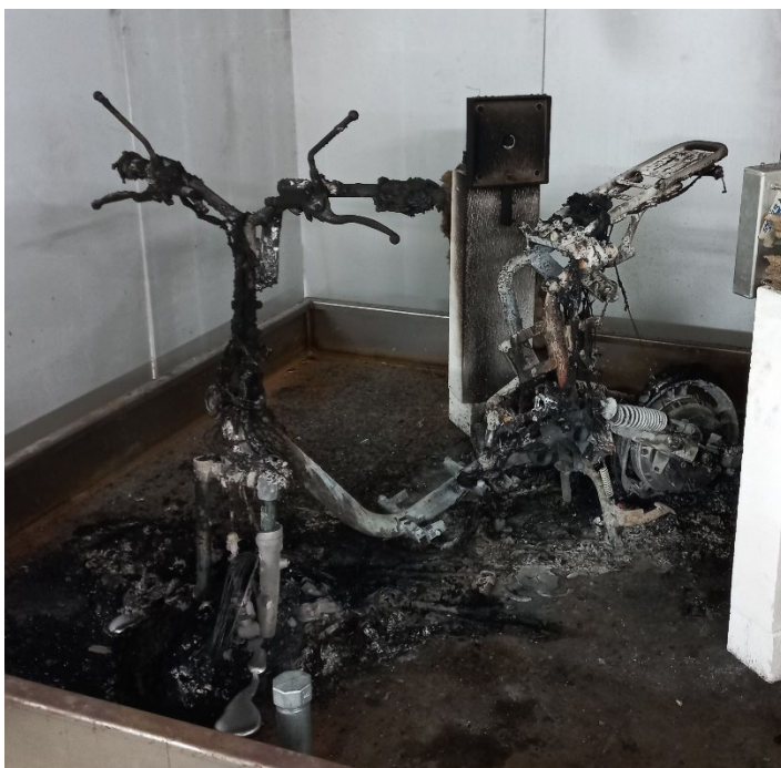
Figuur 2.47 Basismodel elektrische scooter na de test
