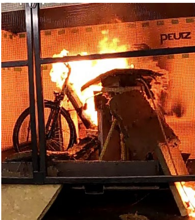
Figuur 2.31 Elektrische fiets met accu in het frame gedurende de test bij piek brandvermogen (t = 98 minuten)
