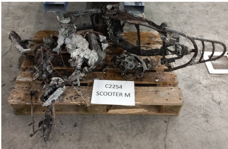
Figuur 2.62 Mid-range model elektrische scooter met windscherm en topkoffer na de test
