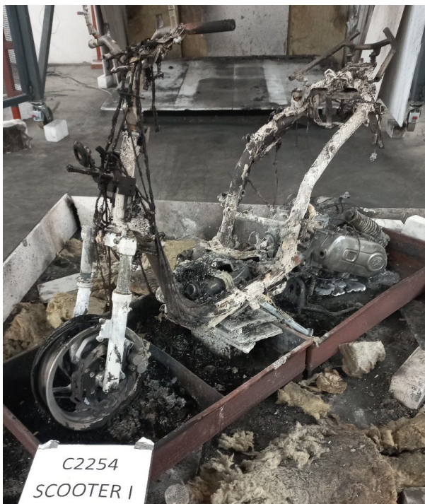
Figuur 2.42 Benzinescooter na de test
