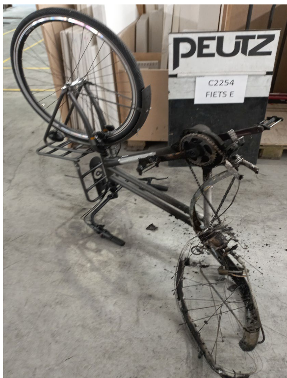
Figuur 2.22 Elektrische fiets met dubbele fietstas na de test
