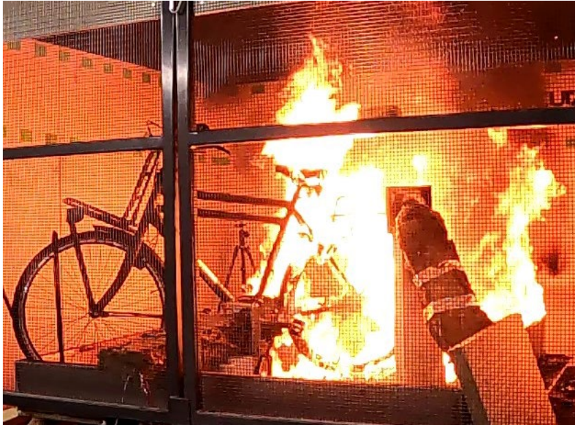
Figuur 2.26 Elektrische fiets met kinderzitje gedurende de test bij piek brandvermogen (t = 9 minuten)
