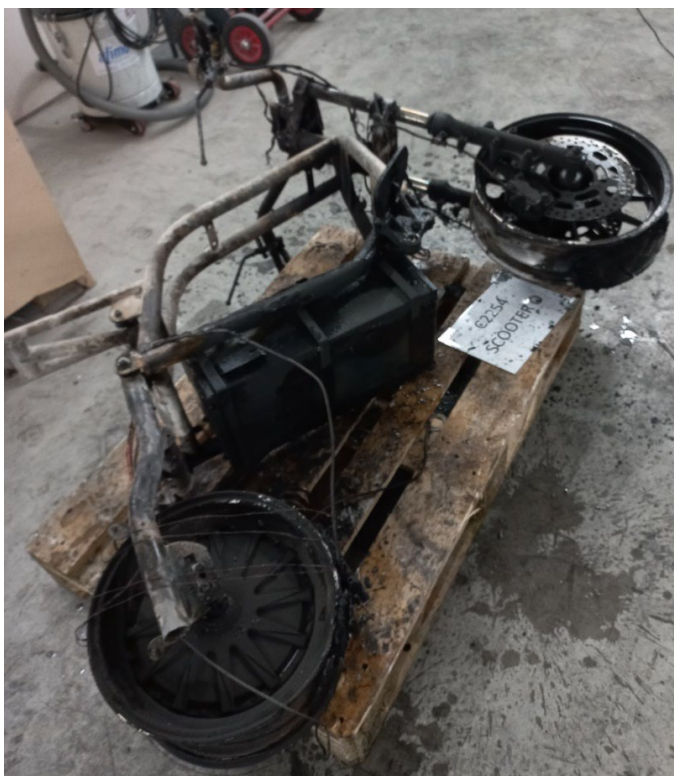
Figuur 2.72 E-chopper elektrische scooter na de test
