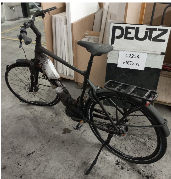
Figuur 2.37 Elektrische fiets met twee accu's na de test
