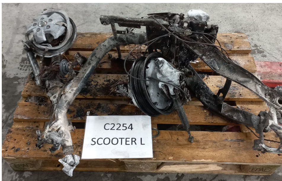
Figuur 2.57 Mid-range model elektrische scooter met windscherm na de test
