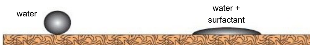
Figuur 3.2 Door toevoeging van een surfactant wordt de oppervlaktespanning van water lager, waardoor het indringend vermogen groter wordt 11
